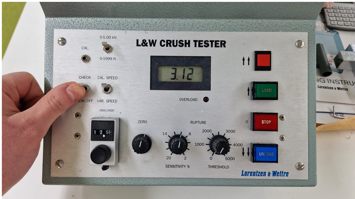
KUVA 4. Lorentzen & Wettre Crush Tester SE 048:n kalibroinnin varmistusta ja hienosäätöä (Maksim Nikolaev 2023).
