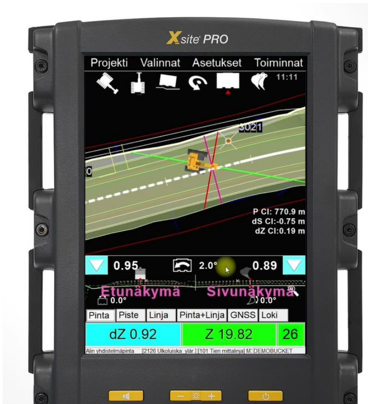
KUVA 4. 3D-koneohajusjärjestelmän näyttöyksiköllä näkyvä toteutuskuva (Novatron)
