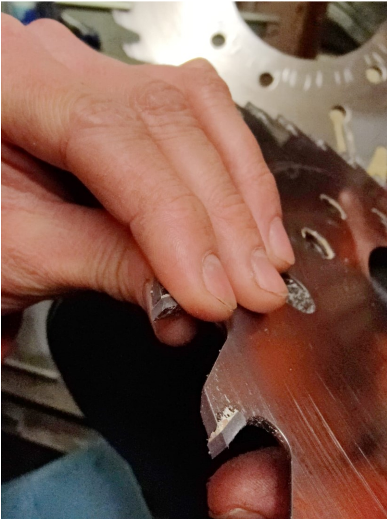
Kuva 22. Otsaterässä sormien välissä oleva hampaan kulma lohjennut, toinen hammas ehjä.
