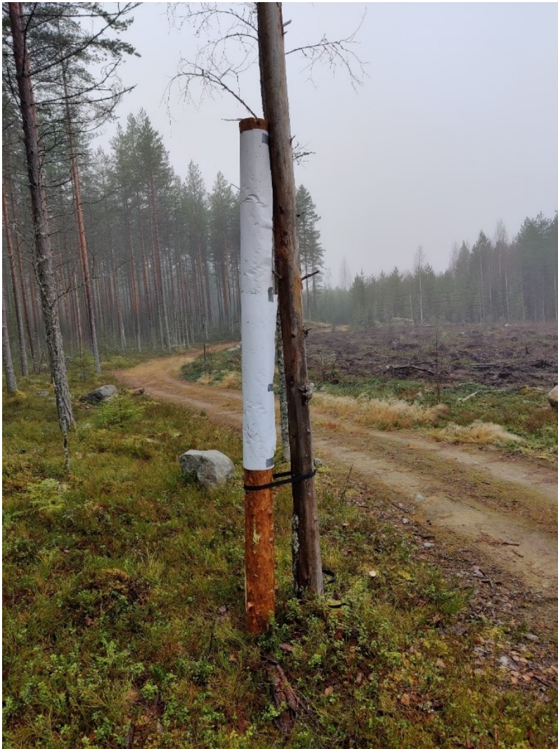
Kuva 13. Ammuttavat pölkkyt pystytettiin keloja vasten.
