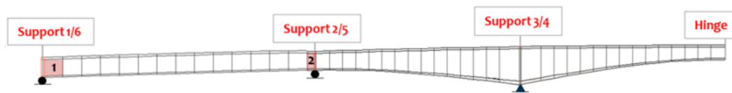
KUVA 12. Kuvassa esitetty tuennat sillan puolikkaalle (Kalix Bridge Project 2022, 164)
