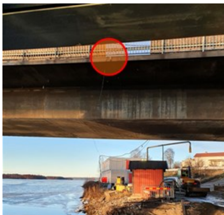
KUVA 30. Taipumamittari D2 keskellä jänneväliä 5 sekä asemointi poikkileikkauksessa. (Kalix Bridge Project 2022, 21 & 24.)
