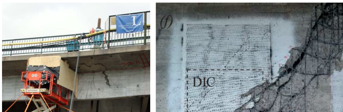
KUVA 22. Kiirunan sillan murtokuormituskoe (Bagge 2017)
