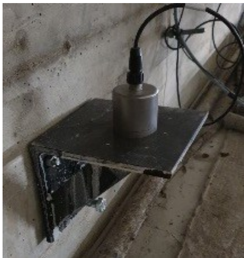
KUVA 40. Kiihtyvyydsmittari mittausspaikalla sillan sisällä sekä mittareiden A1 ja A4 asemointi poikkileikkauksessa esitettynä (Kalix Bridge Project 2022, 23 & 33)
