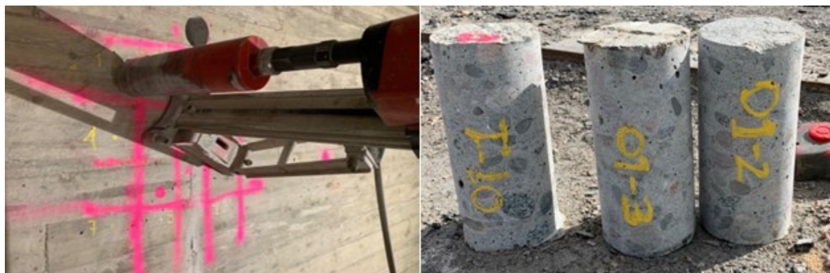
KUVA 20. Kuvassa vasemmalla on kuvattuna näytteenotto betonista. Oikealla on esitetty otettuja näytekappaleita (Kalix Bridge Project 2022, 119–120).
