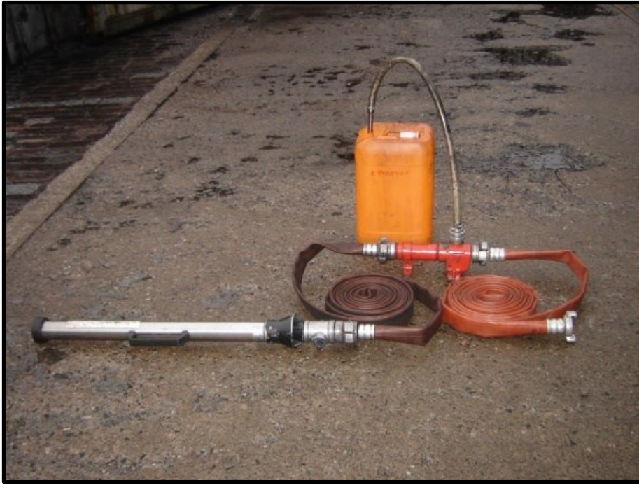
Kuva 2 Raskasvaahtokalusto (400 l/min) (Meriturva 2023)
