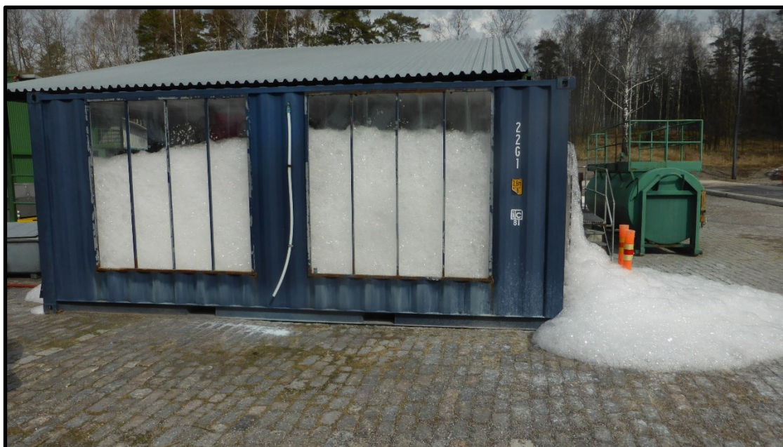
Kuva 10 Vaahdokontti täynnä harjoituskevytvaahtoa (Westerlund 2023)
