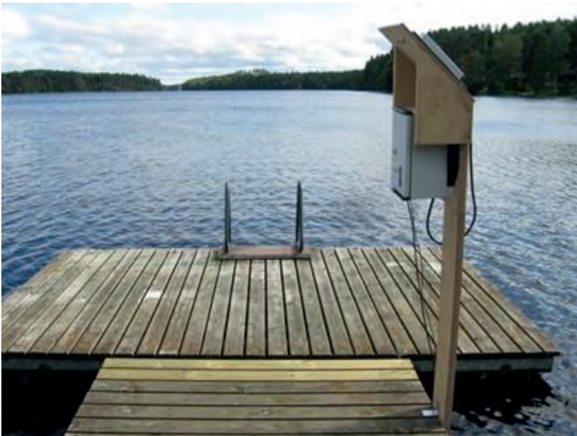
KUVA 5. Sinileväanturi mittaa fluoresenssiin perustuen sinilevän määrää vesi-patsaassa (kuva Piia Aarniosalo)
