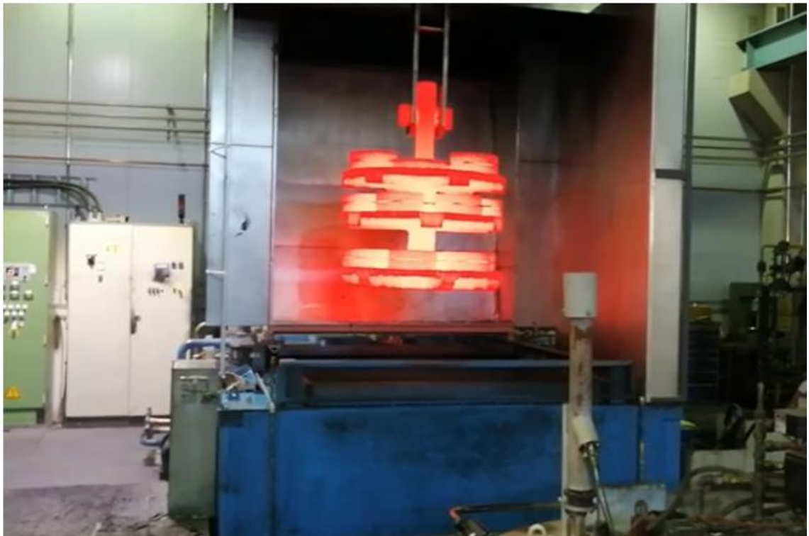
Kuva 6. Hiiletetyn kappaleen siirto sammutusaltaaseen.
