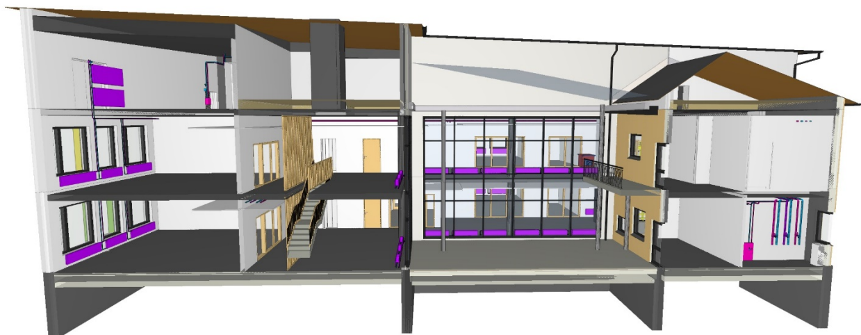
Kuva 1. Leikkauskuva rakennuksen tietomallista, johon on lisätty lämmitysjärjestelmä.
