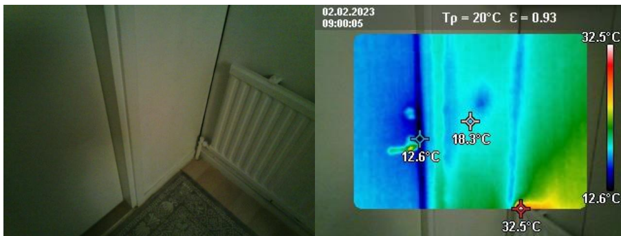
KUVA 18. Ulko-ovi tiivisteet ovi U = 1.0
