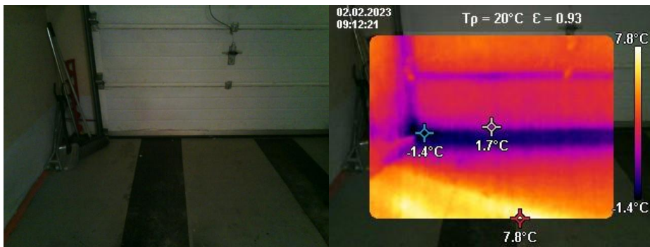
KUVA 12. Autotallin ovi (puolilämmin) U = 1.0
