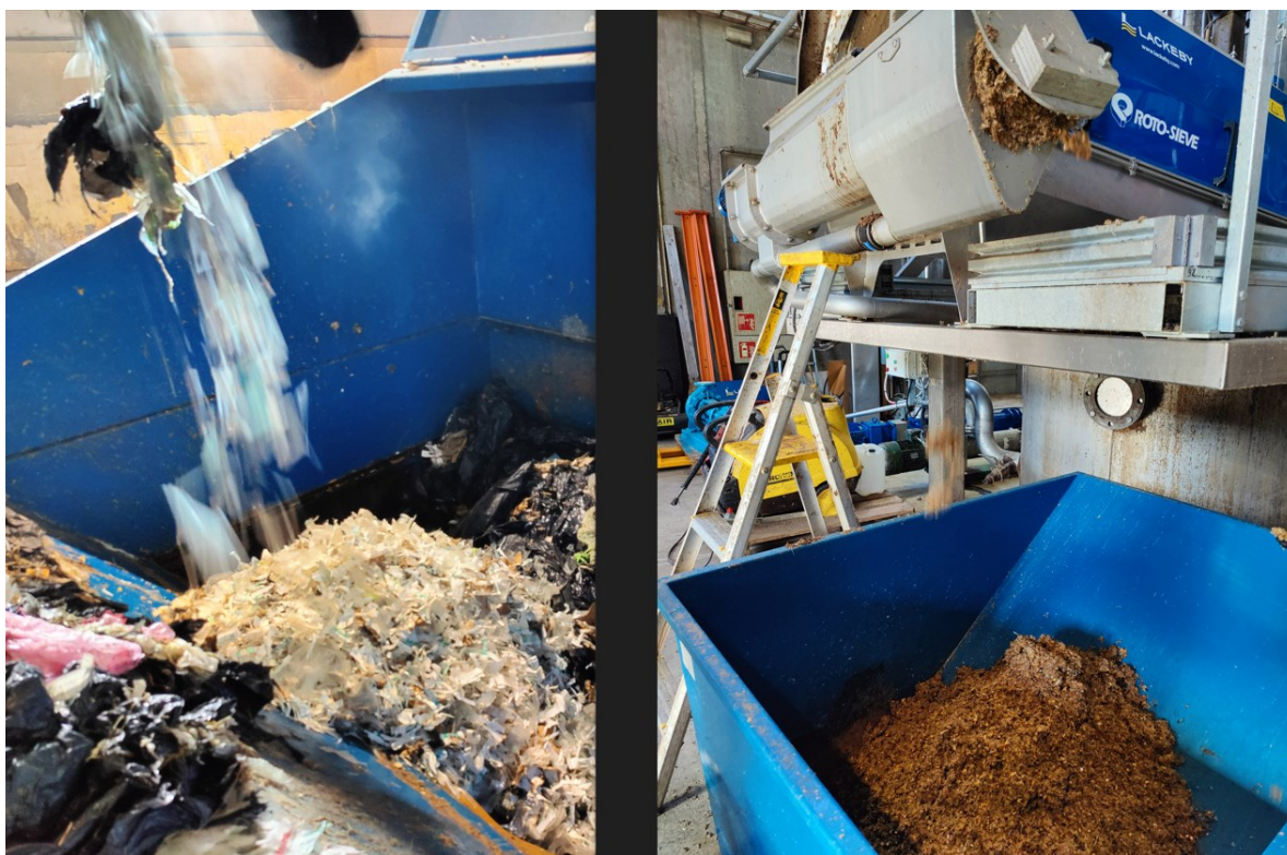
Kuva 17. Sekä repijä-separaattorilta (kuvassa vasemmalla) että rumpuseulalta (kuvassa oikealla) tulevat hylkyjakeet eivät silmämääräisesti arvioituna sisältäneet paljoa vettä (Harri Manu 2022 CC BY-SA).
