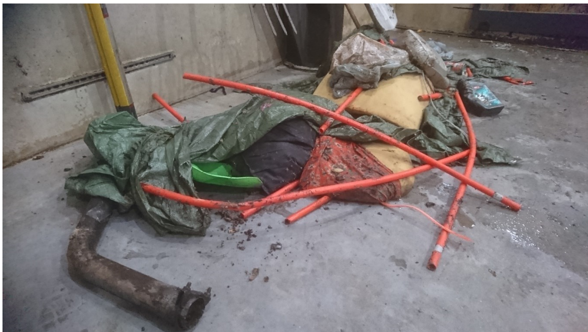
Kuva 28. Biojättesiilosta prosessiin kelpaamattomia, manuaalisesti poistettuja asioita: putkia, aurasviittoja, vaahtomuovipatjoja ja öljykanistereita (Harri Manu 2017 CC BY-SA)
