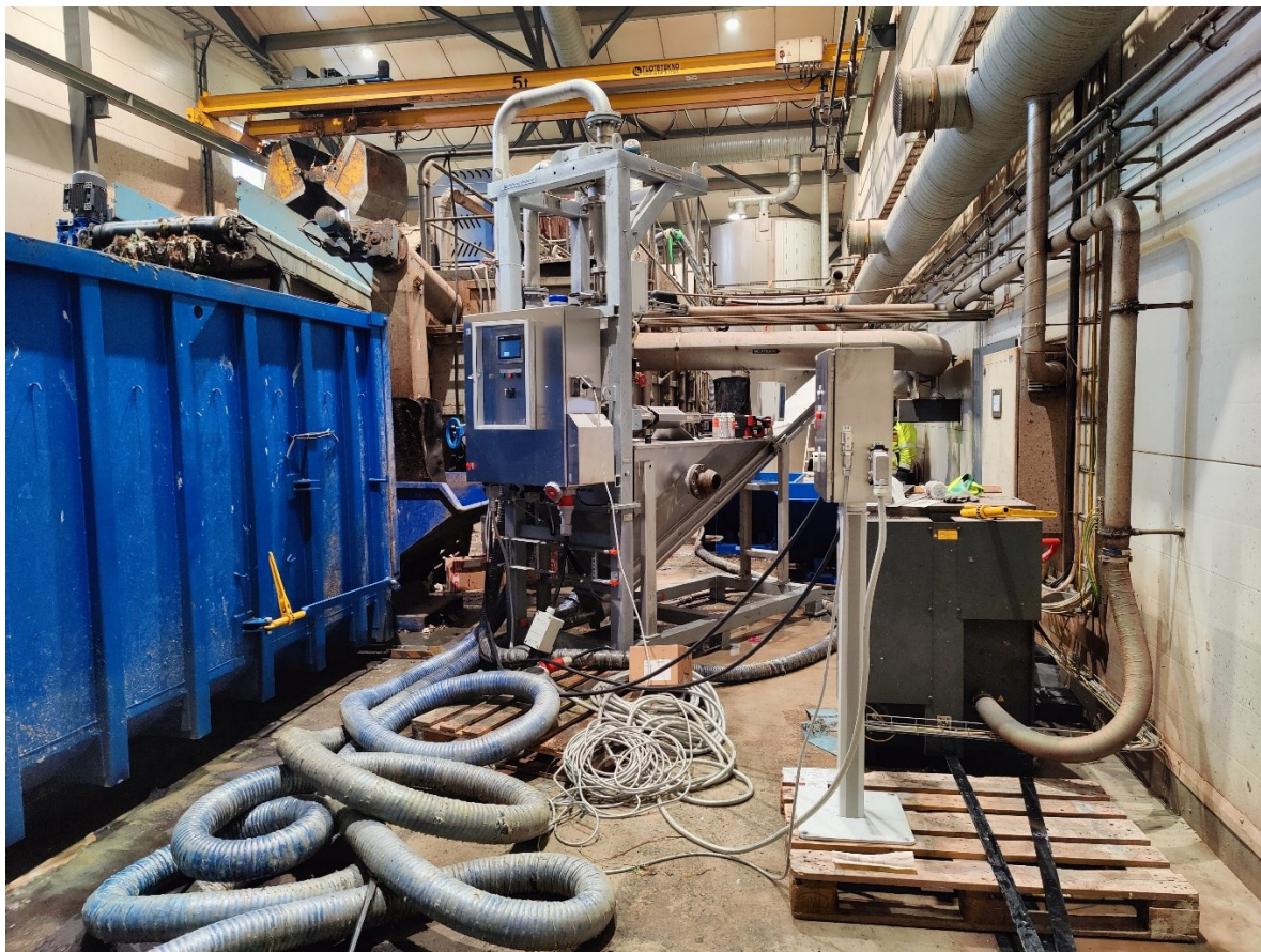
Kuva 40. Hydrosykloni (keskellä) Kuopion biokaasulaitoksella (Harri Manu 2022, CC BY-SA)
