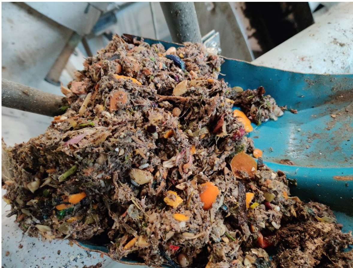
Kuva 34. Ro5-BIO-laitteen hienoväljän poistamaa hylkyä (Harri Manu 2020 CC BY-SA)
