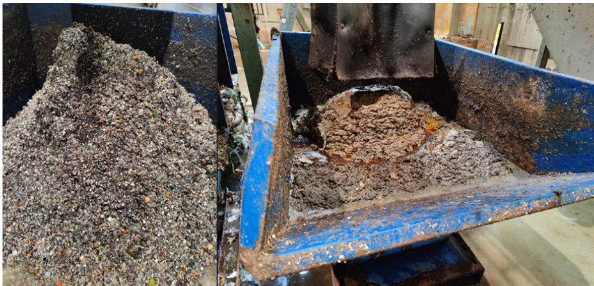
Kuva 35. Vasemmalla Huber-laitteen poistamaa, raskasta hiekka-munankuorihylkyä ja oikealla kevyttä rasva-vaahtohylkyä (Harri Manu 2022)
