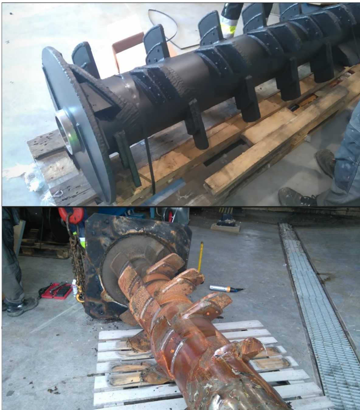
Kuva 31. Yläkuvassa Tiger-laitteen murkaus- ja puristusvaihteen repijäakseli lattialla ennen asennusta ja alakuvassa laitteesta poistettu, kulunut akseli (Harri Manu 2015 CC BY-SA)
