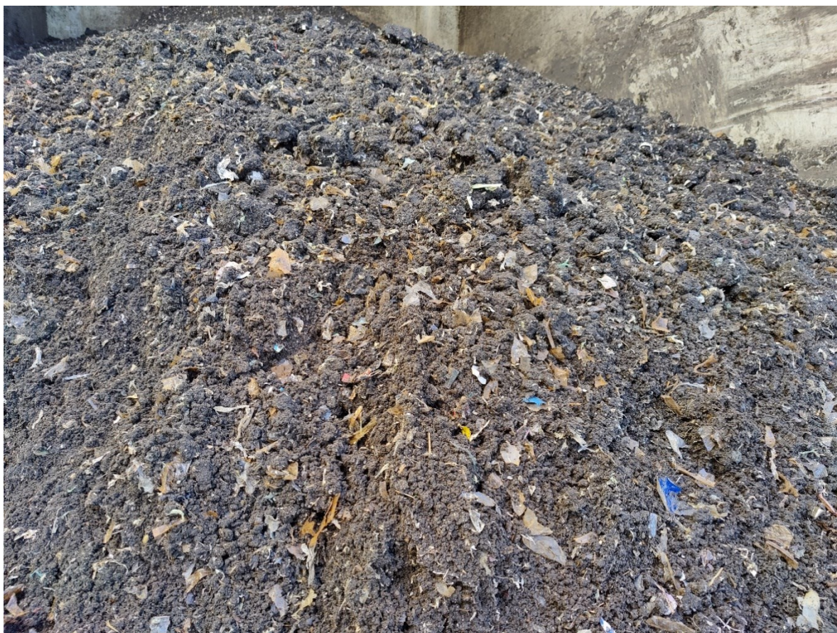
Kuva 9. Runsaasti muovia sisältänyt lannoite-erä Kuopion biokaasulaitoksella (Harri Manu 2022, CC BY-SA)
