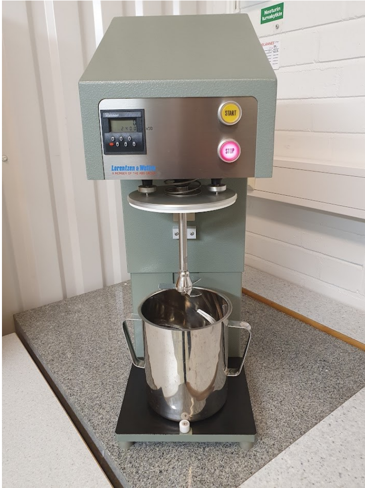
Kuva 18. Toimipaikassa A oleva brittiläinen desintegraattori Lorentzen & Wettre 260.
