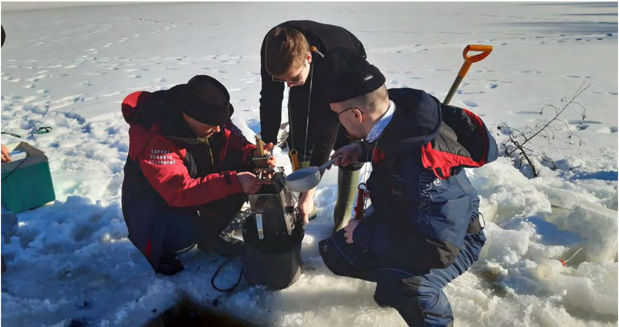
Kuva 16. Vasemmalta lukien Karelia-ammattikorkeakoulun energia- ja ympäristötekniikan opiskelijat Joni-Pekka Saari, Aleksi Särkkä ja Jonne Summanen ottavat Ekman-noutimella pohjaeläinnäytettä Lämminlahdella 17.03.2022.
