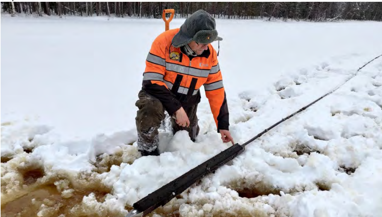
Kuva 17. Tarmo Tossavainen tarkastelee pohjasedimenttinäytettä helmikuussa 2022. Näyte on otettu turvekairalla. Näytteenotto-osan pituus on 1,0 metriä. Kuva: Ismo Pöllänen, Karelia-ammattikorkeakoulu.
