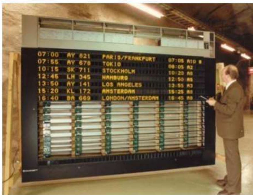
Kuva 2 Ensimmäinen ALD-EL-näyttö asennettiin Helsinki-Vantaan lentoasemalle lähtevien lentojen osastolle vuonna 1983. [3, s. 337.]
