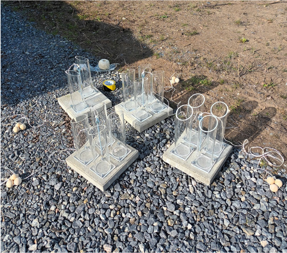
KUVA 2. Hankkeessa suunnitellut ja rakennetut sedimenttikeräimet (kuva Tuija Ranta-Korhonen).
