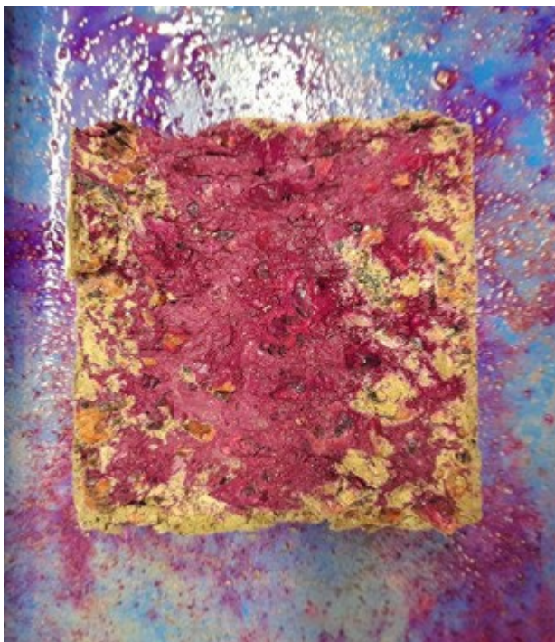
KUVA 1. Karbonatisoituminen paineessa altistetun koekappaleen poikkileikkauspinnalla (kuva Elli Tykkä).
