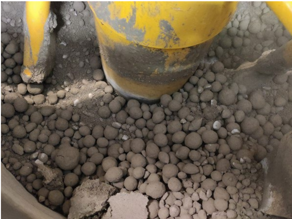
KUVA 3. Tuore betonimassa sekoittimessa, kun hiilidioksidikaasua on lisätty 10 p.-% massaan käytetyn sementin painosta (kuva Elli Tykkä).
