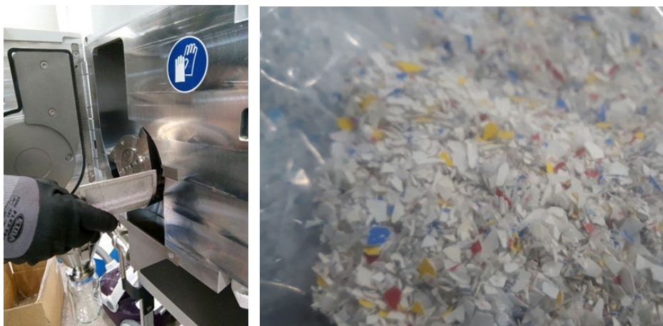
KUVA 4. Leikkumylly (Cutting mill SM 300) vasemmalla (kuva Juha Solio) ja oikealla jauhattua PVC-muovia (kuva Teemu Karttaavi).
