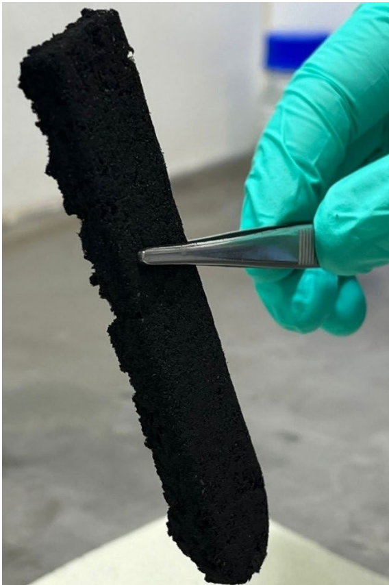
KUVA 4. Lietteestä pyrolysoimalla valmistettua ja rikkihapolla käsiteltyä biohiiltä (kuva Olga Pastushok).
