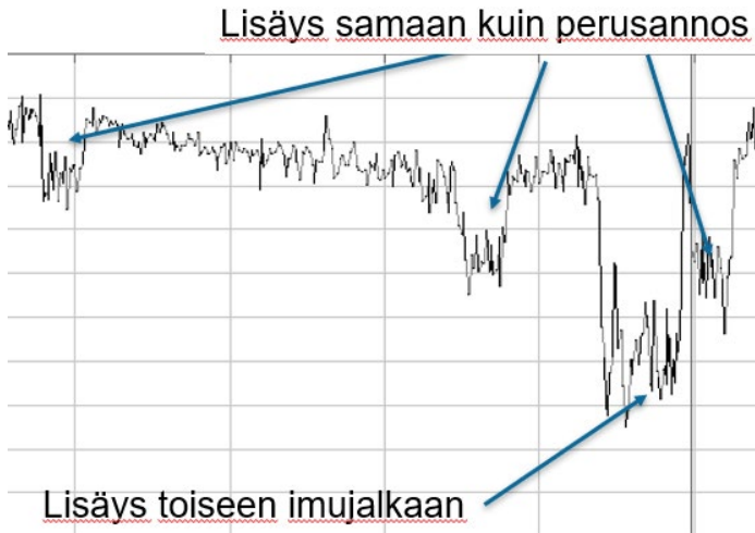
KUVA 8. Vaahdonestoaineen lisäyspaikan vaikutus kaasupitoisuuteen (kuva Jari Käyhkö).
