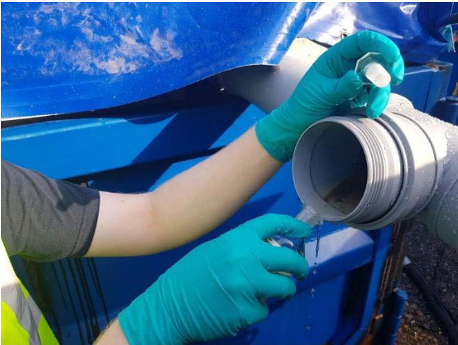
KUVA 1. Suotoveden happipitoisuutta seurataan laboratoriossa tehtävillä analyyseillä (kuva Salla Pulliainen).
