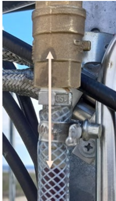
KUVA 4. Jäännöshapen tilavuusosuuden mittaaminen paineistetulla letkulla. Oikeanpuoleisessa kuvassa nuoli osoittaa letkun yläpäähän kerääntyneen kaasun (kuva Jari Käyhkö).
