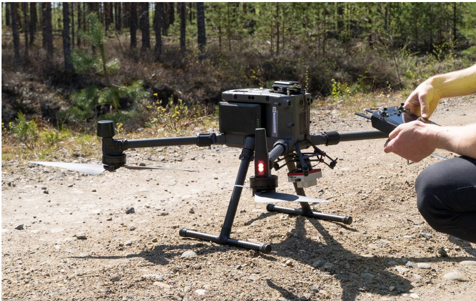
KUVA 1. DJI Matrice 300 -drone ja Micasense RedEdge-MX multispektrikamera (kuva Juha Vihavainen).
