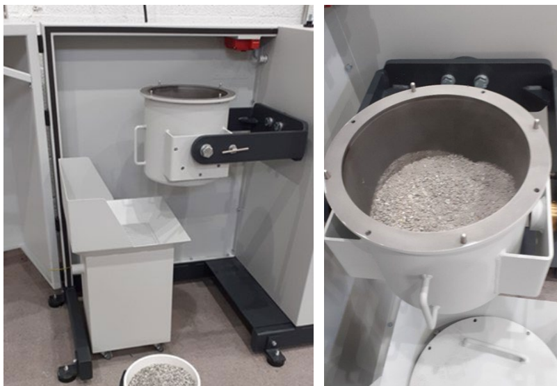
KUVA 5. Kuulamylly ja siinä jauhattua betonia, Drum mill TM 300 (kuva Teemu Karttaavi).
