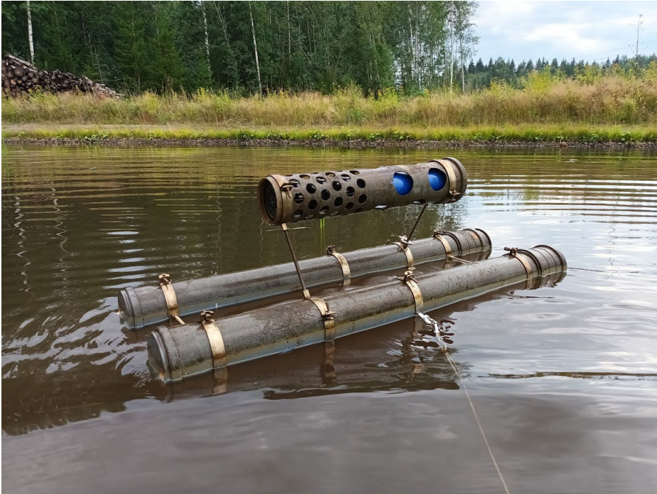
KUVA 1. Toinen Hula-hankkeessa rakennetuista sondikellukkeista käännettynä ylösalaisin huoltotoimenpiteiden ajaksi. Kuvassa näkyvät kaksi pitkää putkea toimivat kellukkeina sekä ylimpänä näkyvä pienempi rei'itetty putki sisältää itse vedenlaatumittarin. Kokonaisuus kiinnitettiin vajereilla rantaan (kuva Aki Mykkänen).
