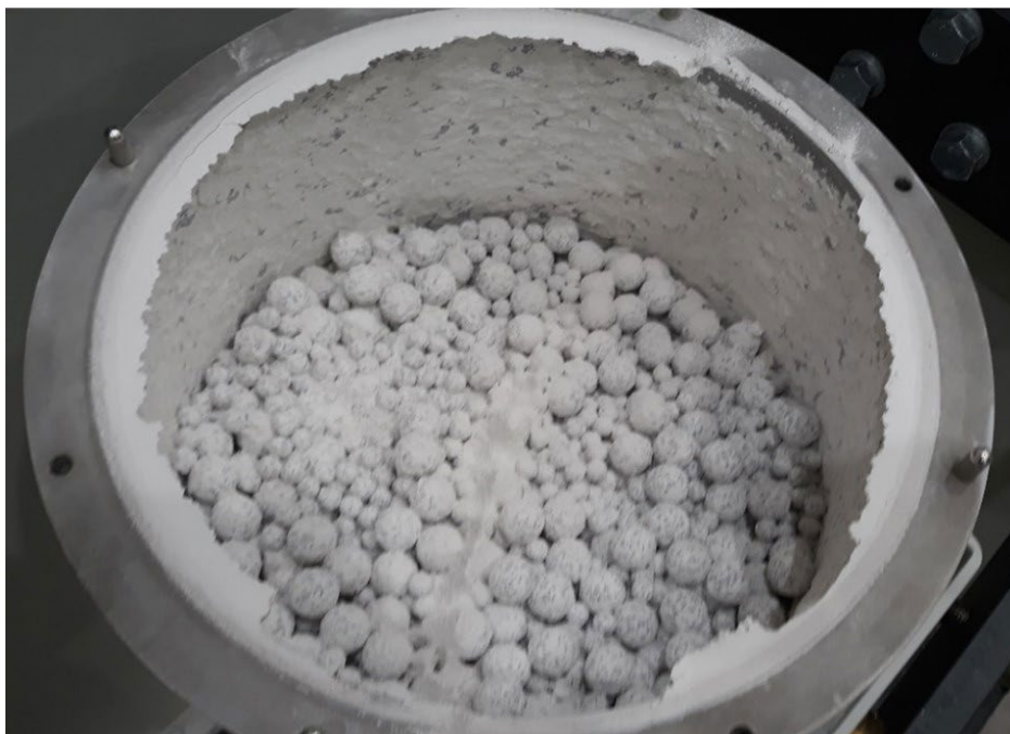
KUVA 2. BioSammassa kuulamylyssä jauhattua lasia (kuva Teemu Karttaavi).
