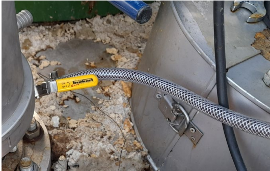
KUVA 4. Jäännöshapen tilavuusosuuden mittaaminen paineistetulla letkulla. Oikeanpuoleisessa kuvassa nuoli osoittaa letkun yläpäähän kerääntyneen kaasun (kuva Jari Käyhkö).
