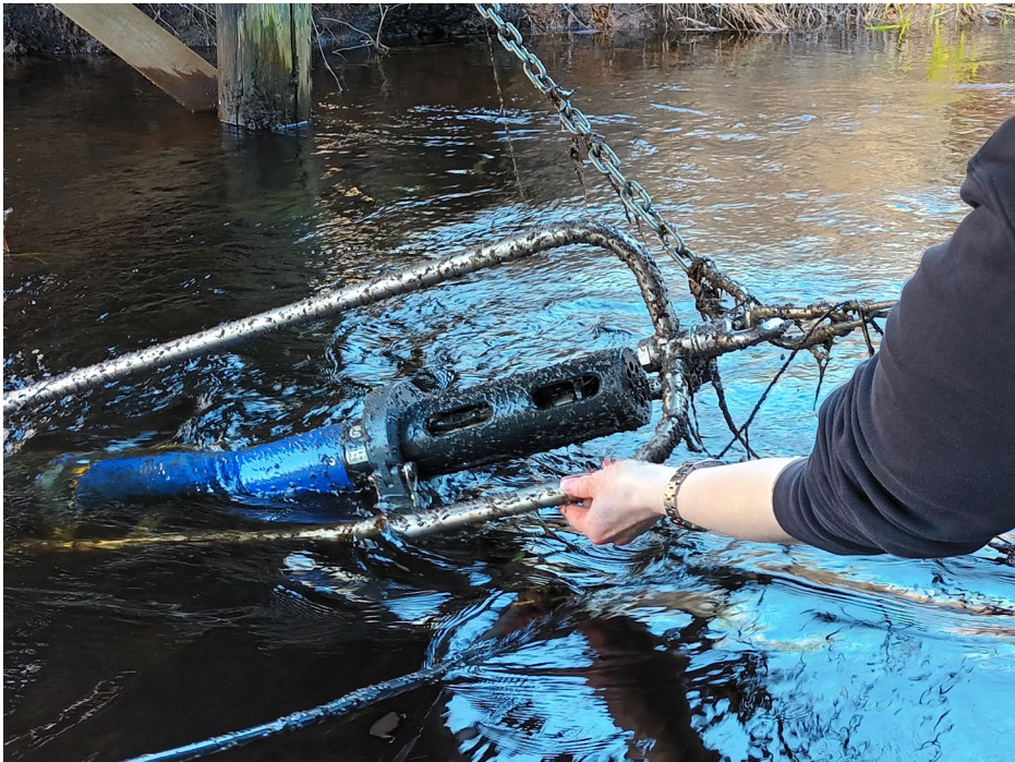
KUVA 3. Piste 1 vedenlaatuasema huoltokäynnin yhteydessä toukokuussa 2022. Kuvassa näkyvä YSI EXO-2 -vedenlaatumittari on asennettuna NexSensin suojahäkkiin. Häkki sekä mittari olivat hyönteistoukkien peitossa, jotka heikensivät muun muassa optisen sameusanturin tuloksia (kuva Aki Mykkänen).
