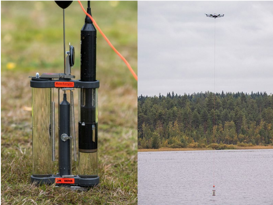
KUVA 6. Drosens Oy:n vesinäytteenottimen näytteestä mitataan YSI ProDSS kenttä-laitteella vedenlaatua. Oikealla puolella DJI Matrice 600 -drone, jossa on kiinnitettynä vesinäytteenotin. (Kuva Aki Mykkänen)
