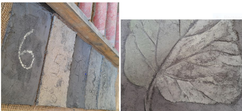
KUVA 4. Biohiililaastiseosnäytteitä ja biohiilimaalin tarttuvuuskoetta (kuvat Outi Tuomela)
