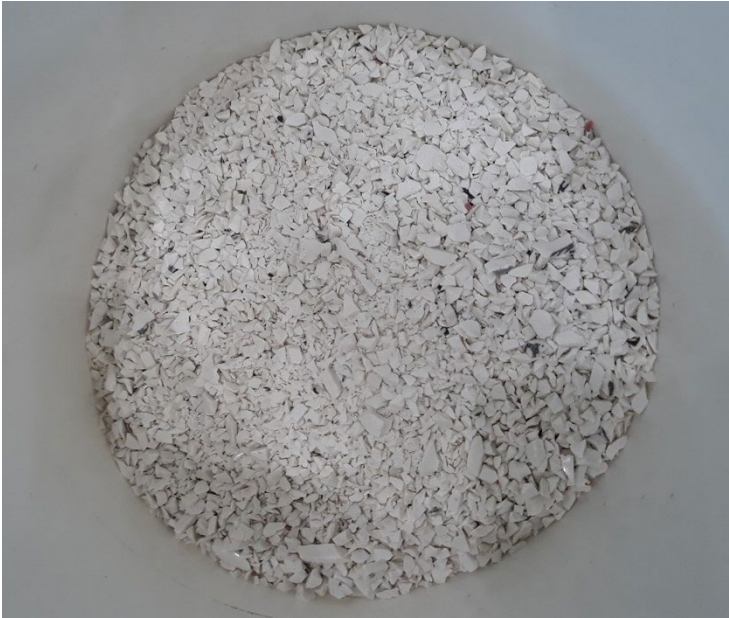
KUVA 3. BioSammossa leukamurskaimella hienonnettua posliinia (kuva Teemu Karttaavi).
