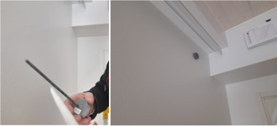
KUVA 2. Piikkimittari (vasemmalla) ja piikkimittari asennettuna paikalleen (oikealla) (kuvat Aarno Hatsala).
