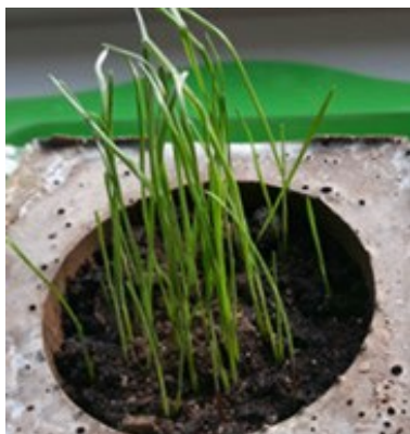
KUVA 1. Kierrätetystä tiilijauheesta tehty geopolymeeriruukku, jossa kasvaa istutettua heinää (kuva Teemu Karttaavi).
