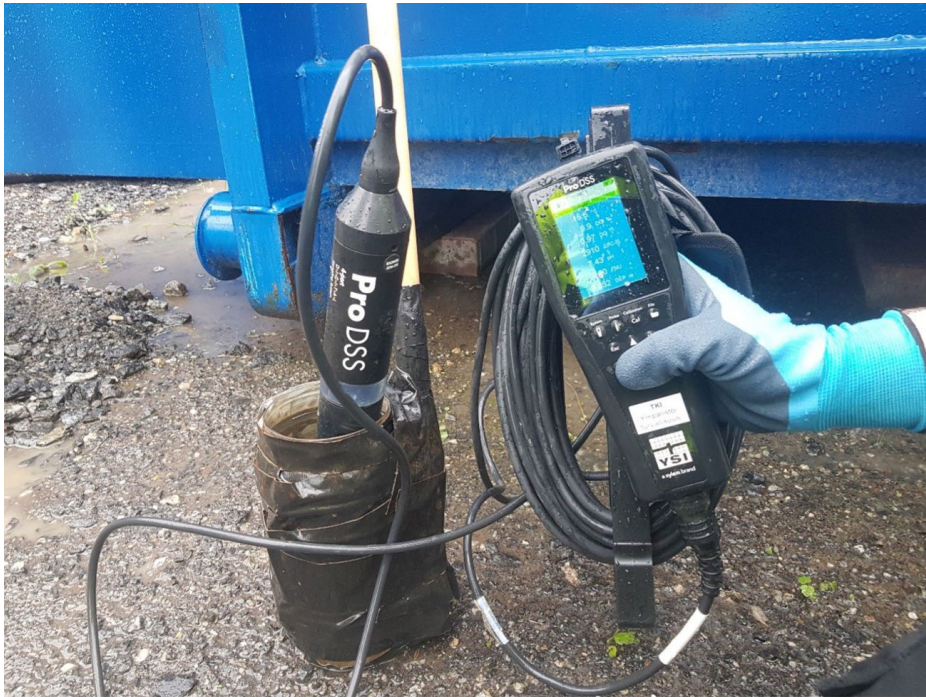
KUVA 2. Biosuodatusjärjestelmässä puhdistettavan veden happipitoisuutta seurataan Ysi ProDSS -kenttämittarilla (kuva Salla Pulliainen).
