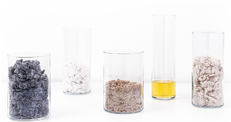
KUVA 3. Kemiallisesti kierrätetyn tekstiilin vaiheita. Kuvassa vasemmalta oikealle on kuvattu mekaanisesti esikäsiteltyä kierrätyskuitua, kemiallisesti esikäsiteltyä kierrätyskuitua, kemiallisesti käsiteltyä (karbamoitua) selluloosaa, liuotettua selluloosaa ja lopuksi regeneroitua kehrättyä kierrätystekstiilikuitua (kuva IFC).
