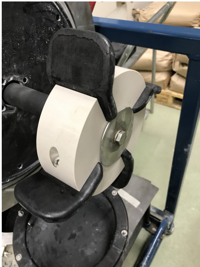
Kuva 10. Nykyisen Slurry pot 1:n sekoittaja ja sekoittajan lavat.
