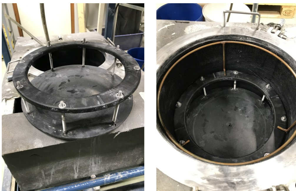
Kuva 8. Vasemmalla puolella on Slurry pot 1:n näyteteline ja oikealla puolella laitteen näyteteline on kiinnitetty laitteen pesään metallituella.
