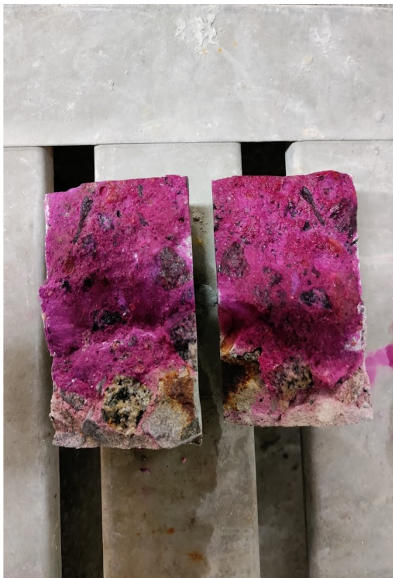
Figur 14. Bilden visar karboniseringsdjupet.
