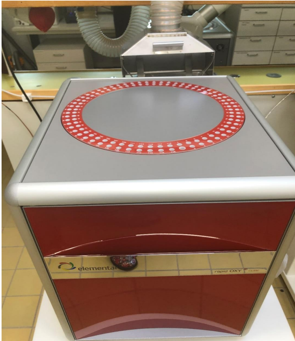
Kuva 2. Laite yläviistosta. Kattotason numeroitu kiekko on näytesampleri.
