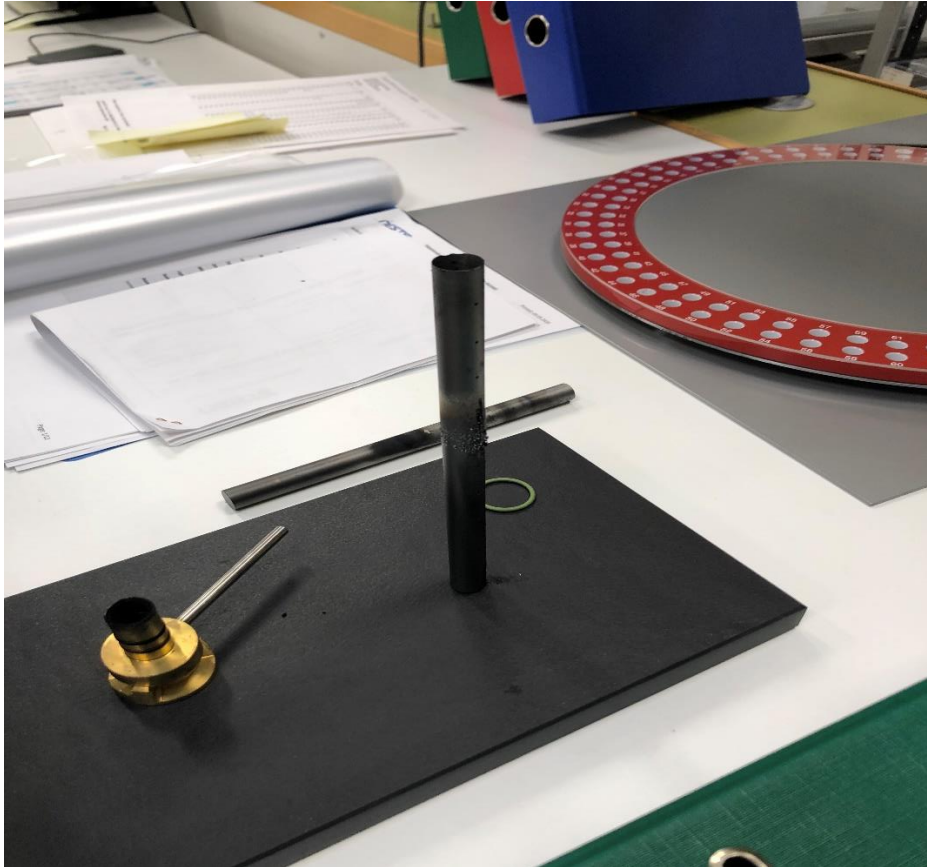
Kuva 5. Tuhkakuppi ja kiinnityskappale. Tuhkakupin päälle kerrostuu näyteistä hiiltä ja näytekupista hopeahilettä.
