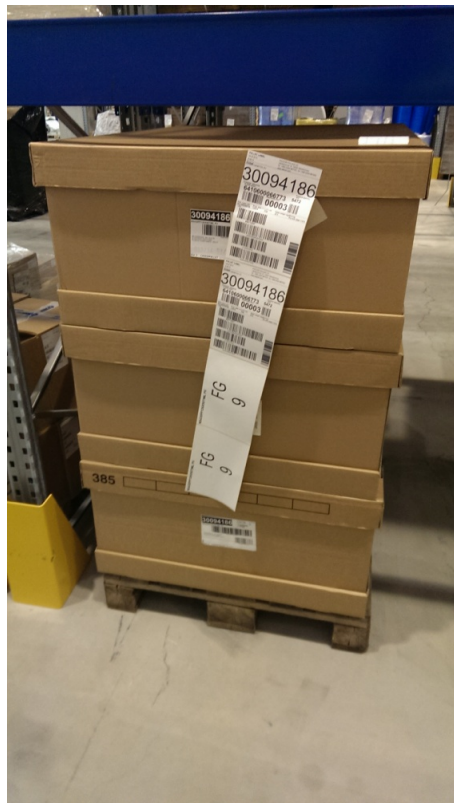
Kuva 5. Puolivalmista tuotetta, johon on kiinnitetty 2 lavalappua ja 2 LOT-tarraa. (Kuva: Antti Koivisto 2014)
