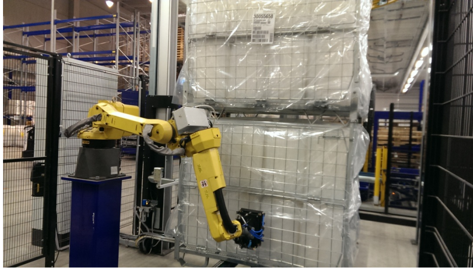
Kuva 2. Fanuc M-10iA tarroitusrobotti ja häkkipakattuja tuotteita. (Kuva: Antti Koivisto 2014)
