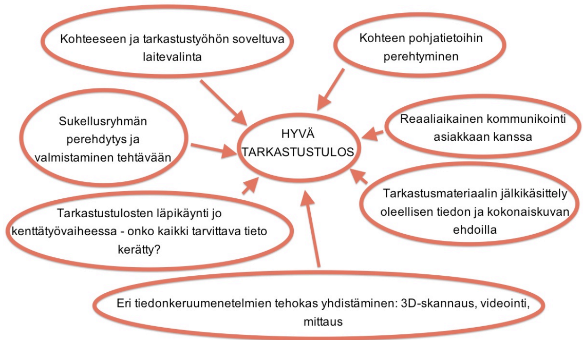
Kuva 21. Huomioitavia seikkoja pyrittäessä hyvään vedenalaisrakenteen tarkastustulokseen
