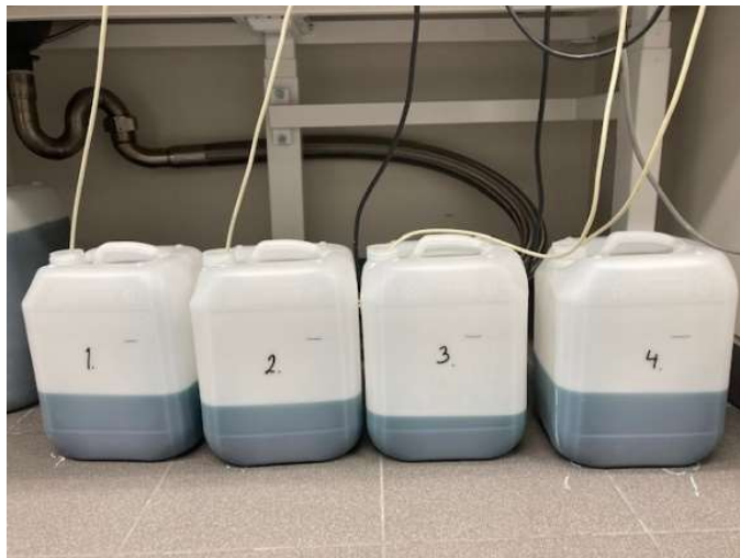
Kuva 10. Kanistereiden liuostilavuudet kokeiden1-4 päätyttyä.
