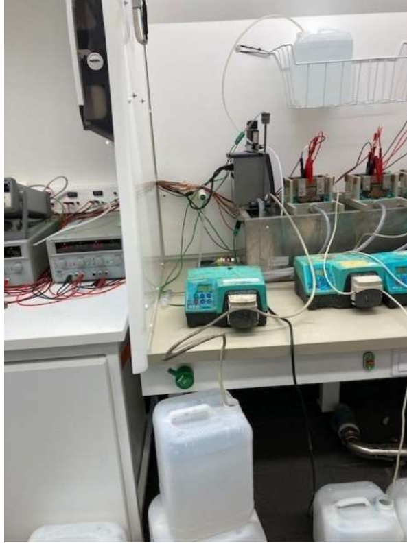
Kuva 11. Lisätty letkupumppu vedelle.
