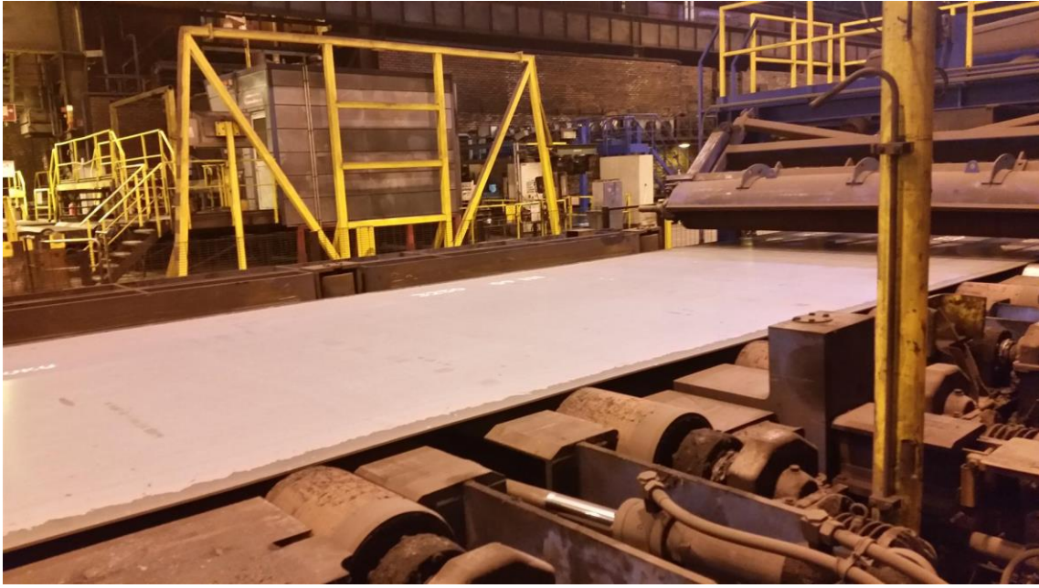
KUVA 14. Normalisoitu levy harjauksen jälkeen
