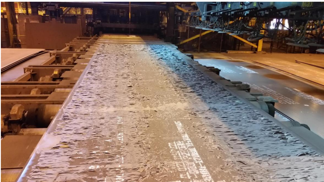
KUVA 15. Levyn pinta oikaisun jälkeen vanhalla oikaisukoneella
