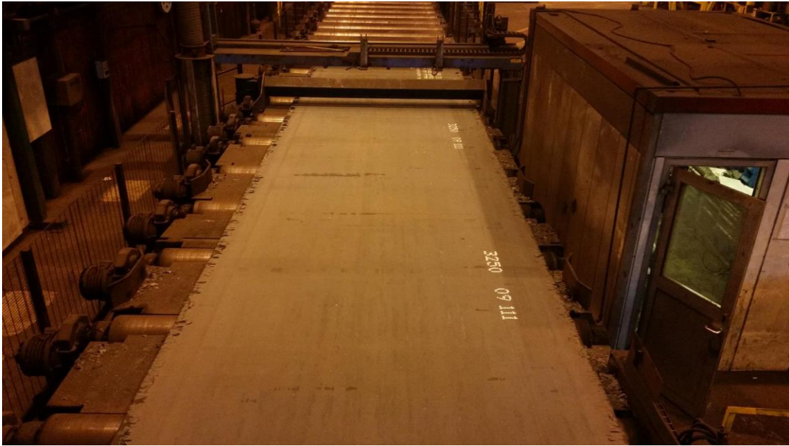
KUVA 13. Hilsepinta murtuu reuna-alueilta sivuleikkauksen seurauksena
