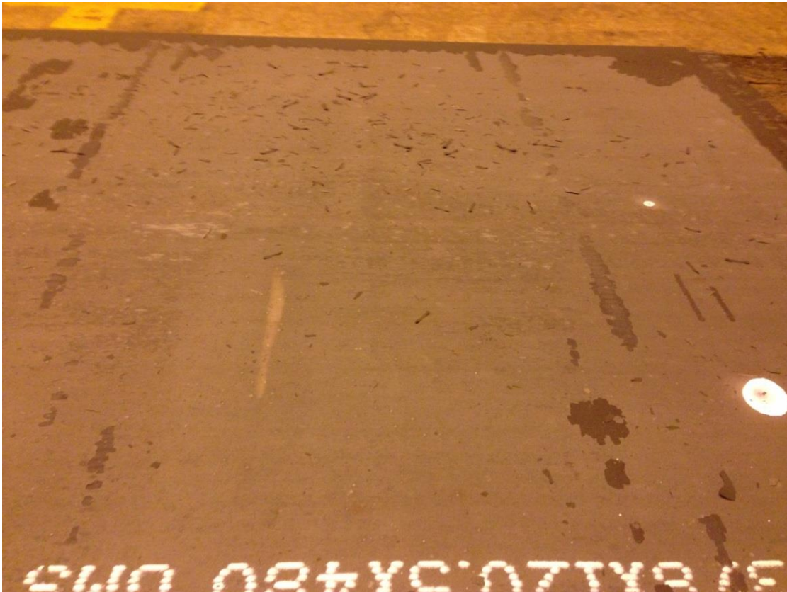
KUVA 8. Normalisoitu levy, jonka paksuus on alle 80 mm
