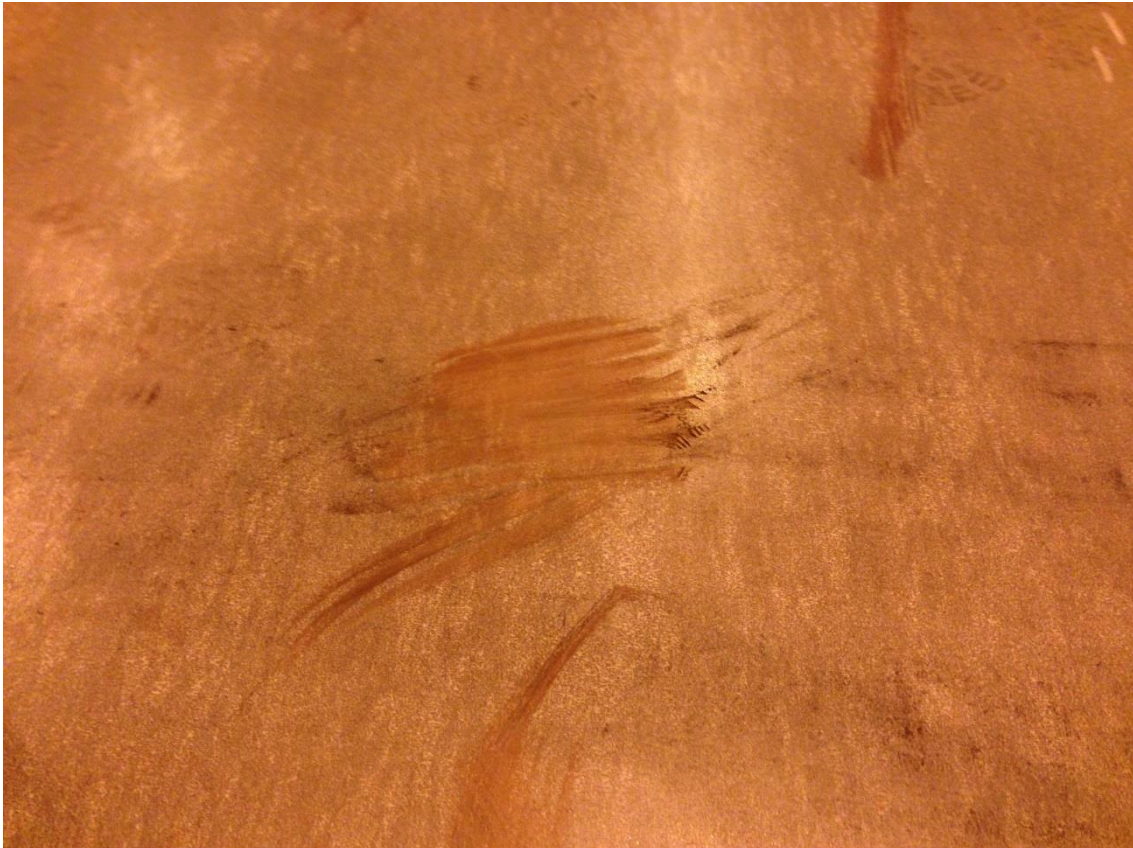
KUVA 9. Nuorrutettu levy, joka on oikaistu
