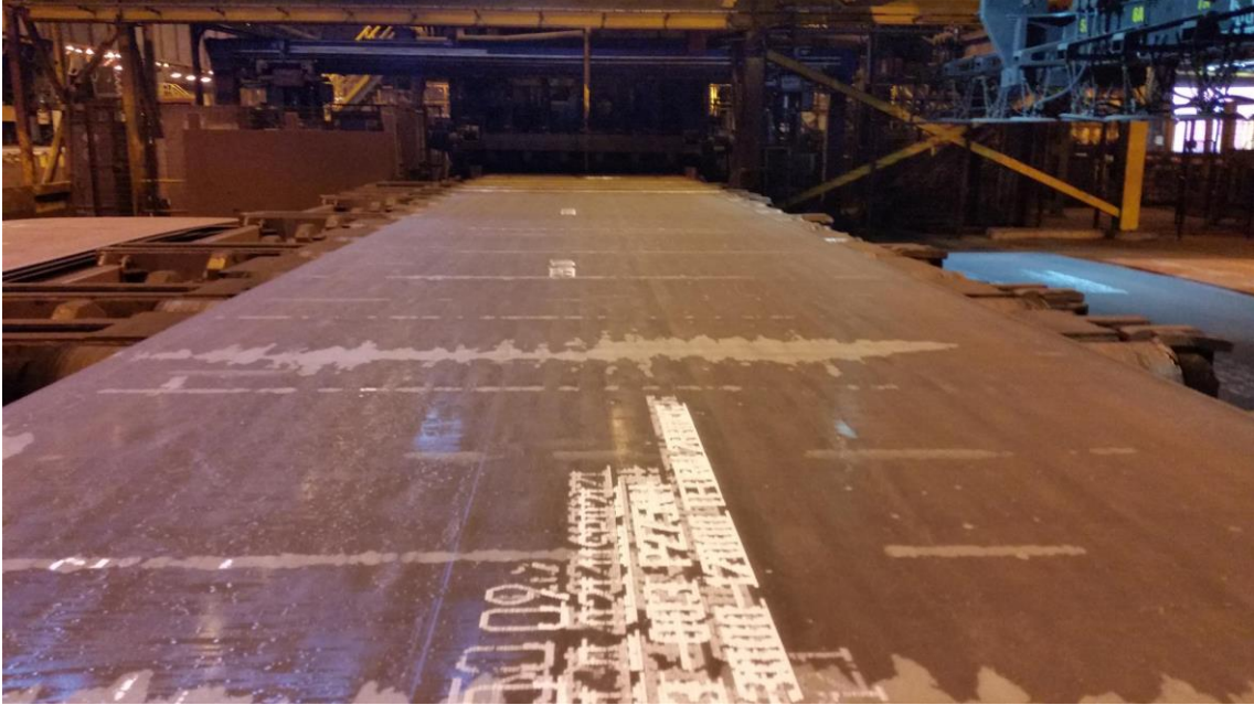
KUVA 16. Levy on oikaistu uudestaan uudella oikaisukoneella
