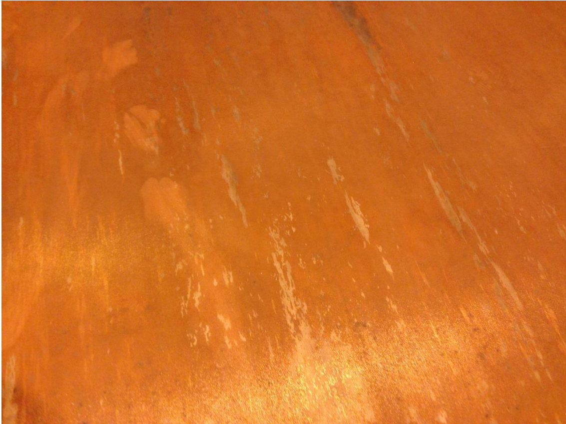
KUVA 6. Kulutusteräs levy, jota ei ole oikaistu
