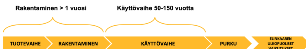
Kuva 1. Rakennuksen elinkaaren vaiheet (mukaillen Rakennusteollisuus RT ry s.a.; Ympäristöministeriö s.a.)
