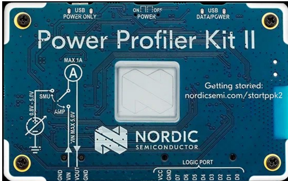
KUVA 6 Power Profiler Kit II on Nordic Semiconductorin pienten virtojen mittaukseen kehittämä laite (8.)
