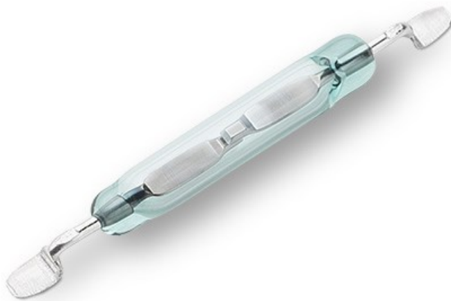
KUVA 3 Reed-kytkimen kaksi johdinta voidaan kytkeä toisiinsa laitteen kuoren läpi magneetin avulla. (6.)
