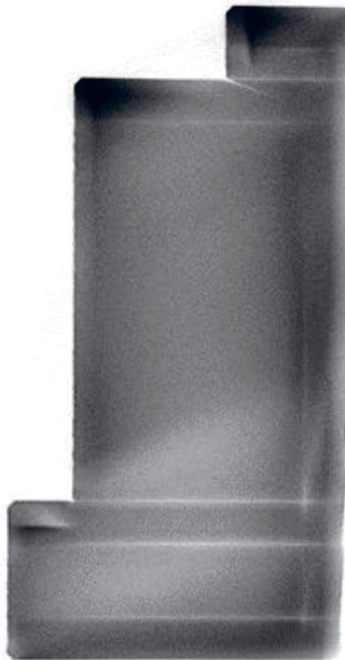
Kuva: Työkaluteräksestä tulostettu osa, jossa näkyy selkeä halkeama ylhäällä sisäkulmassa. Kuvaushäiriöt (mm. vaaleat viivat ja sävyvaihtelut tasaisella pinnalla) ovat selkeitä tiheillä metallikappaleilla.
