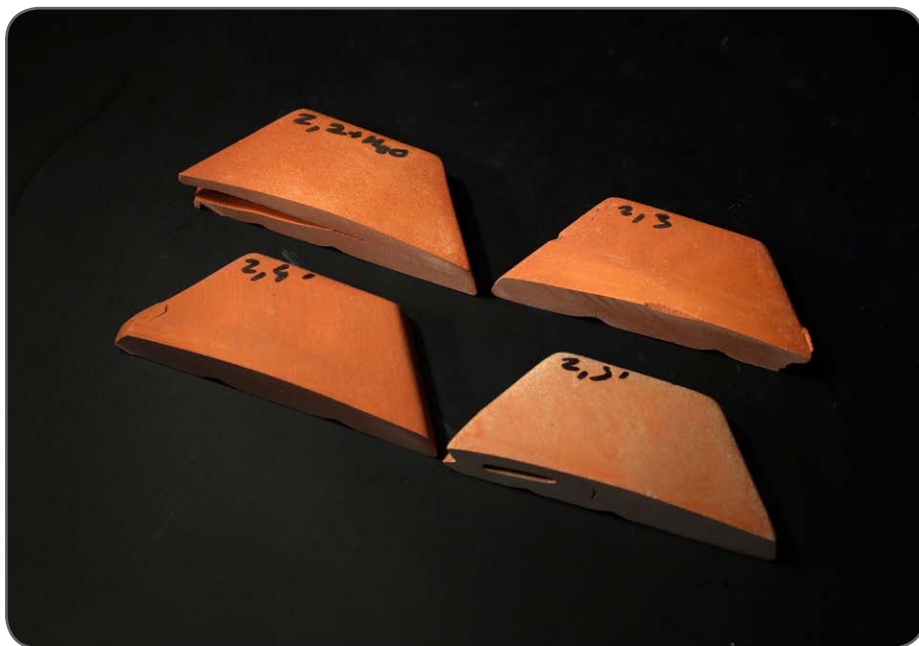
Kuva 19. Umpivalumuoteissa massa ei päässyt täyttämään muuttia korkean tiksotropian vuoksi ja esineen sisään syntyi ilmatasku. Lasin määrän kasvaessa väri muuttui vihreäksi.
