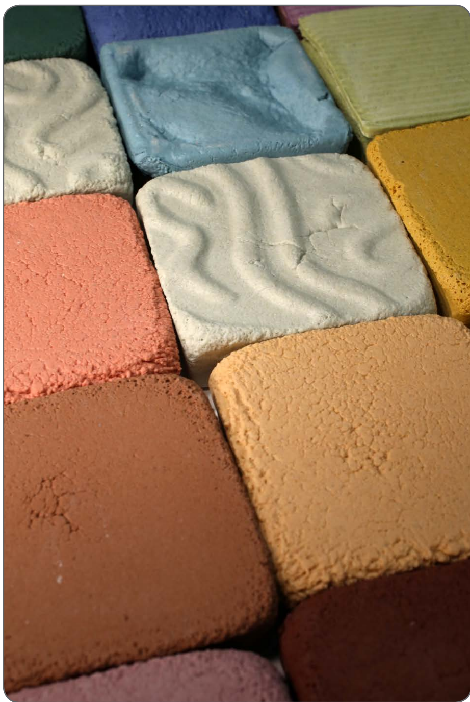
Kuva 28. Tuotekehitysvaiheessa olevia vaahtolaselementtejä sisustus- ja rakennuskäyttöön (Luostarinen 2014).
