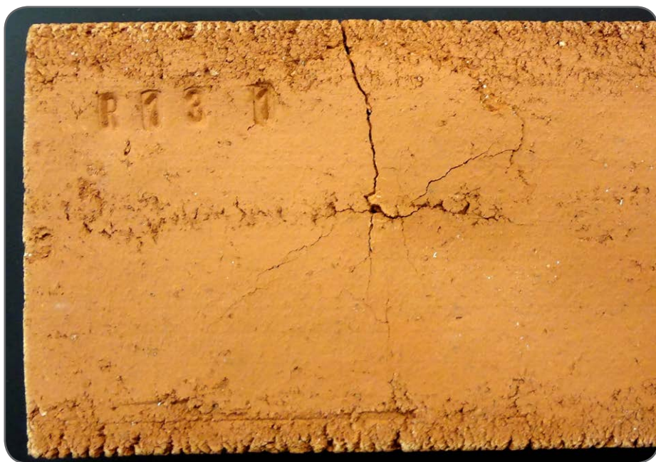
Kuva 12. Esimerkki pakkaskokeen aiheuttamasta vauriosta massassa 13.1, jossa vahtolasijauhetta oli 5 %.
