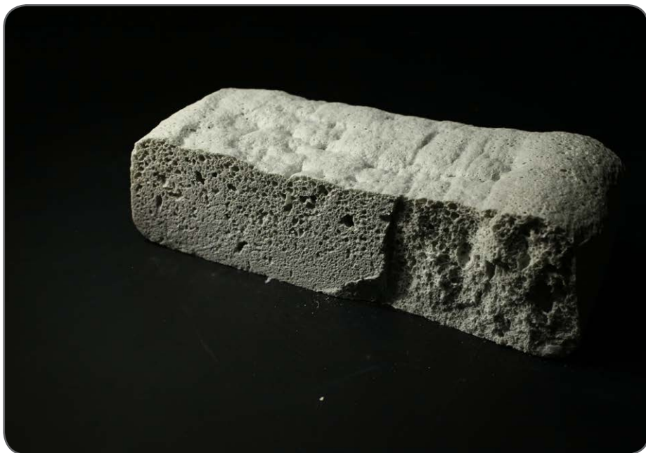
Kuva 6. Kaasu-uunissa poltettu vaahtolasikoe (Kaija & Lindqvist 2012).
