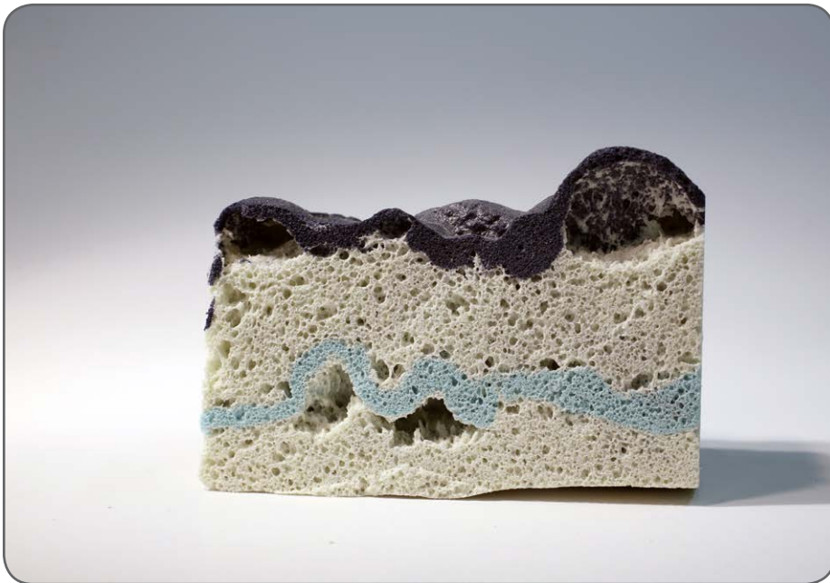
Kuva 20. Eriväriset kerrokset eivät vaahdotuksessa sekoittuneet. Päälimmäinen värikerros ei tässä lämpötilassa vaahdotunut lainkaan, vaan muodosti sintraantuneen, lasitemaisen pintakerroksen. (Kallioinen 2012.)
