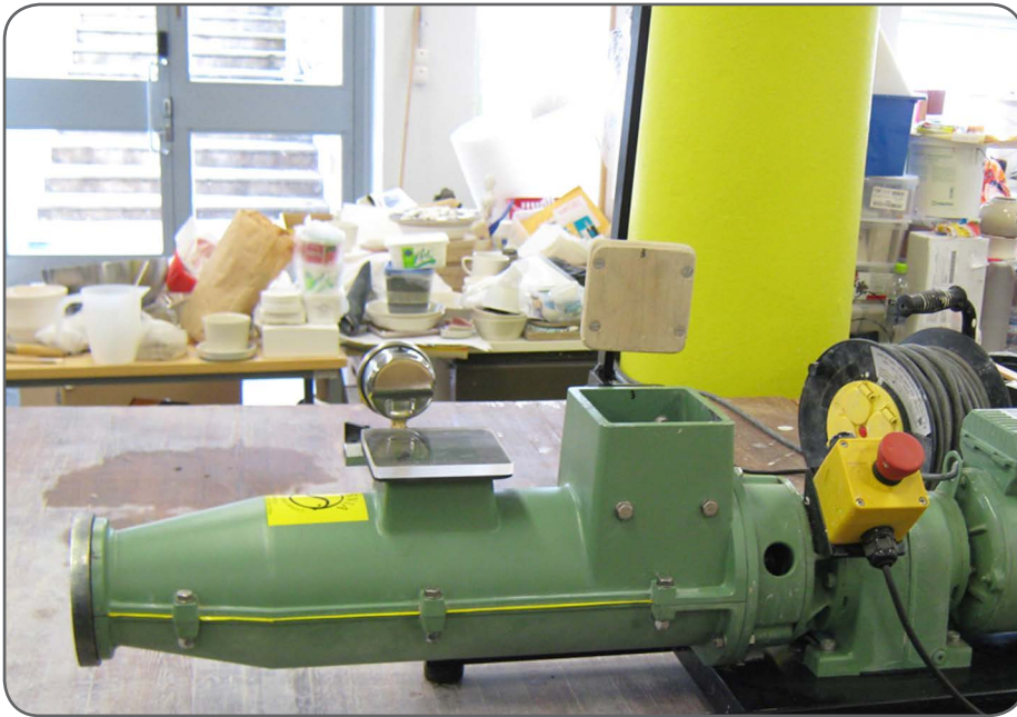
Kuva 6. Venco-tyhjiösuulakepuristin, jossa ulostulevan saven halkaisija on 75 mm (3") (Auvinen 2012b, 1).
