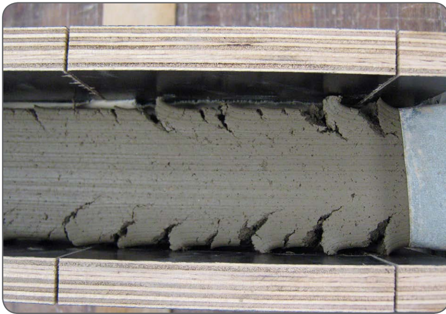
Kuva 9. Punaisen tiilimassan suulakepuristus ei onnistunut, koska koneesta ulos tullessaan massan reunat repeilivät pahasti. Venco-puristimessa ongelmaa yritettiin korjata oikeassa reunassa näkyvällä ohjauksellilla, mikä ei kuitenkaan auttanut repeilyyn.
