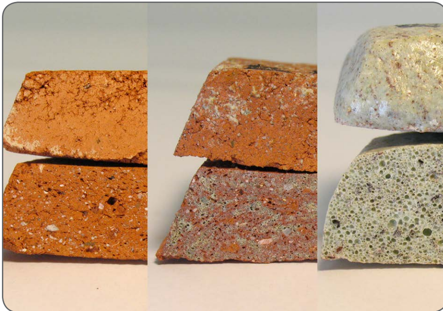
Kuva 4. Poikkileikkauskuvissa näkyy punasavimassan tiivistyminen ja lasin sulaminen lasin määrän kasvaessa ja lämpötilan noustessa. Koemassat vasemmalta: (P) ei lasia, poltto 1000 °C; (DP) lasia 40 %, poltto 1000 °C; (EP) lasia 60 %, poltto 1030 °C. (Auvinen 2012a, 12, 14.)
