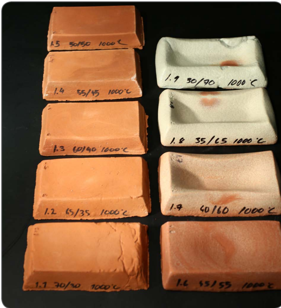
Kuva 17. Koemassat, joissa lasijauheen määrä oli yli 55 %, alkoivat sulaa ja menettää muotoaan 1000 °C:n lämpötilassa (Ylitalo 2013, 15).
