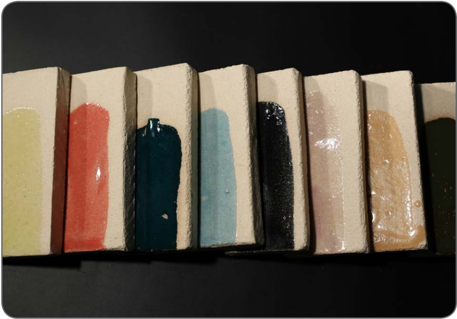
Kuva 3. Engobe-koesarjan 3 värisävyt poltonjälkeen. Lasijauhe toimii hyvin sulattajana engobessa. Vasemmalta oikealle järjestyksessä IA - IG.
