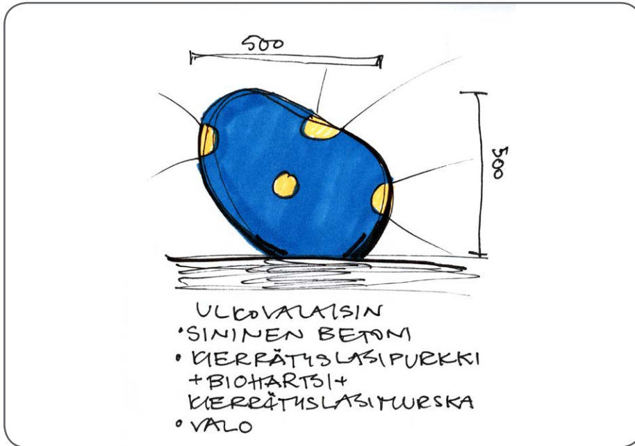
Kuva 13. Betoninen ulkovalaisin: värjätty betoni, biohartsikierrätyslasimurskavalu.
