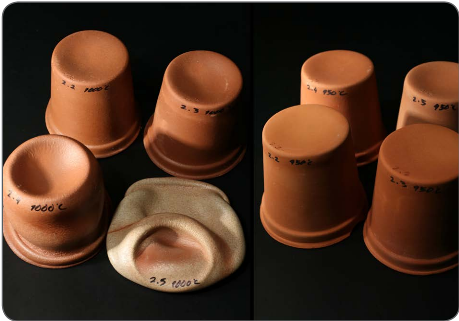
Kuva 18. Vasemmalla massat, joissa lasijauhetta oli 30–50 %, menettivät muotoaan 1000 °C:ssa. Sen sijaan oikealla avovalettu mukit poltettiin 950 °C:een eikä massan sulamista vielä tapahtunut. (Ylitalo 2013).
