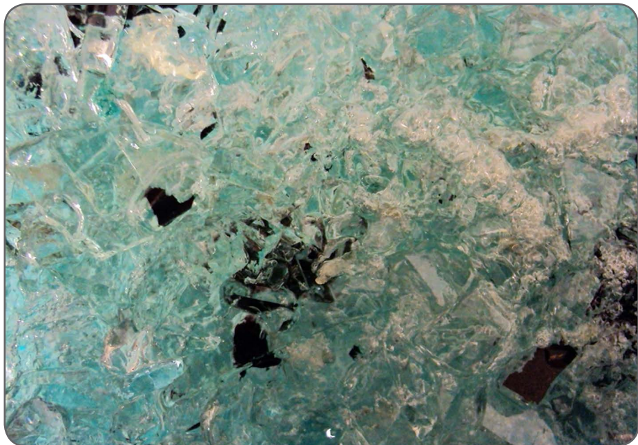
Kuva 8. Koepala: Seulottua ja pestyä tuulilasimurskaa biohartsiin valettua.
