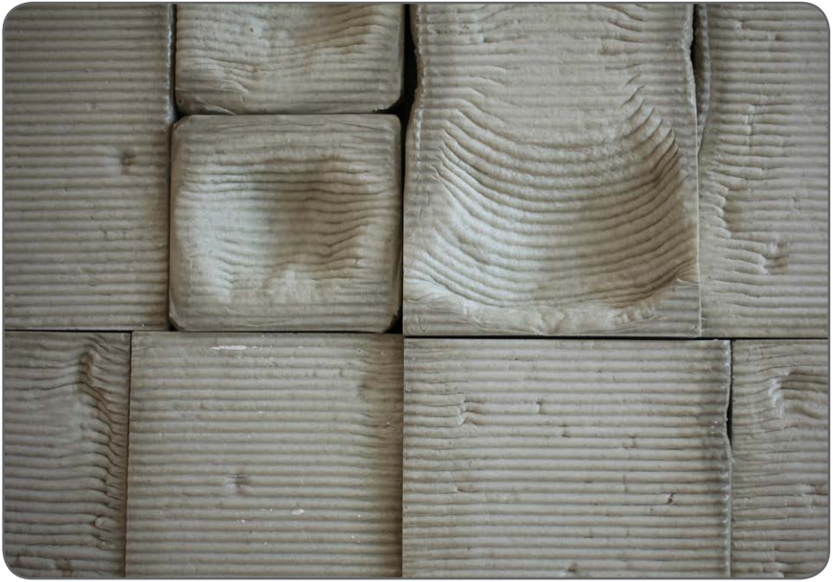
Kuva 18. Vahtolasilaattoja koottuna koeseinämäksi. (Vesterinen 2014).
