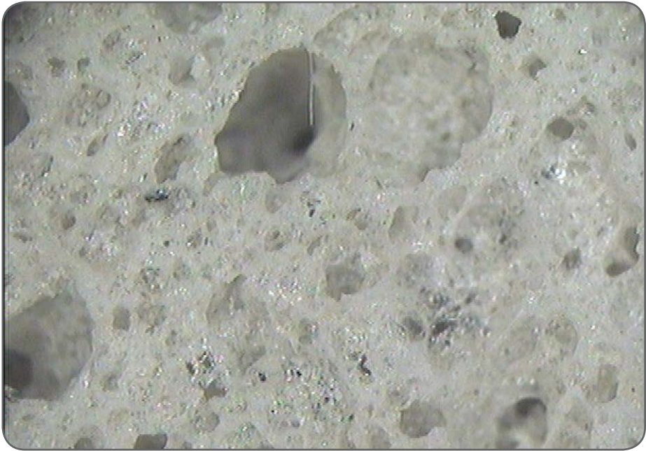
Kuva 8. Mikroskooppikuva avoimesta vaahtolasirakenteesta.
