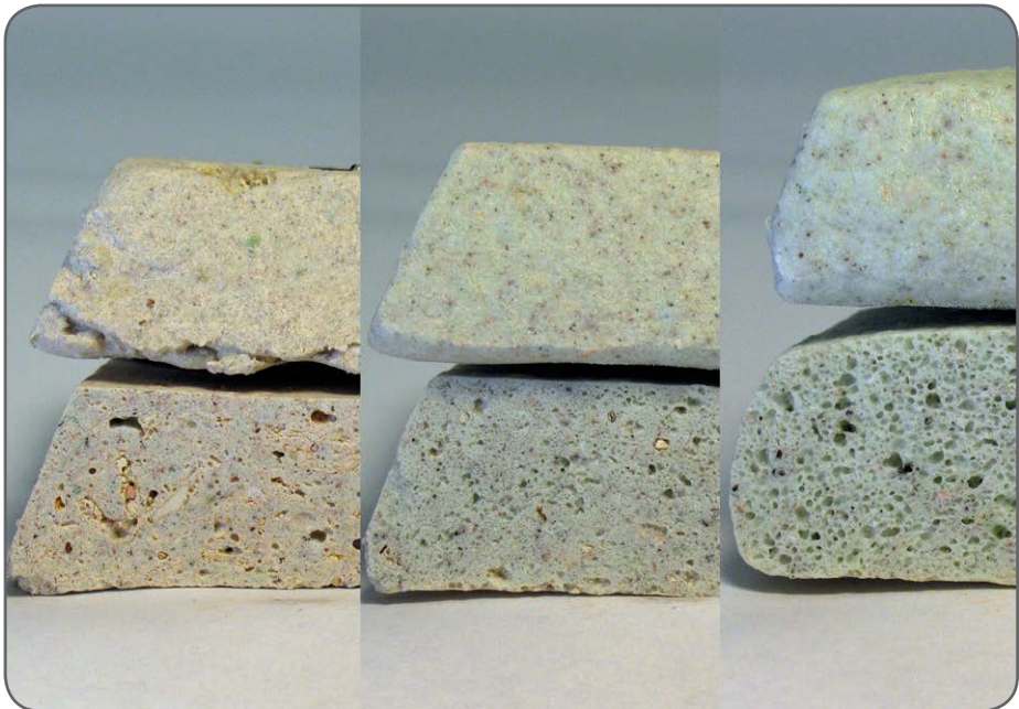
Kuva 5. Poikkileikkauksissa näkyy valkoisen massan sulaminen ja lasin kiehuminen lasijauheen määrän kasvaessa ja lämpötilan noustessa. Koemassat vasemmalta: (DV) lasia 40 %, poltto 1030°C; (EV) lasia 60 %, poltto 1030°C; (EV) lasia 60 % poltto 1060°C. (Auvinen 2012a, 24, 16.)
