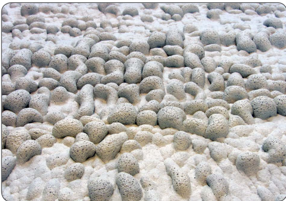
Kuva 11. Koeajossa tehtaalla vaahtolasin pinta oli aluksi täynnä pieniä pullistumia, osin liian korkean lämpötilan vuoksi.
