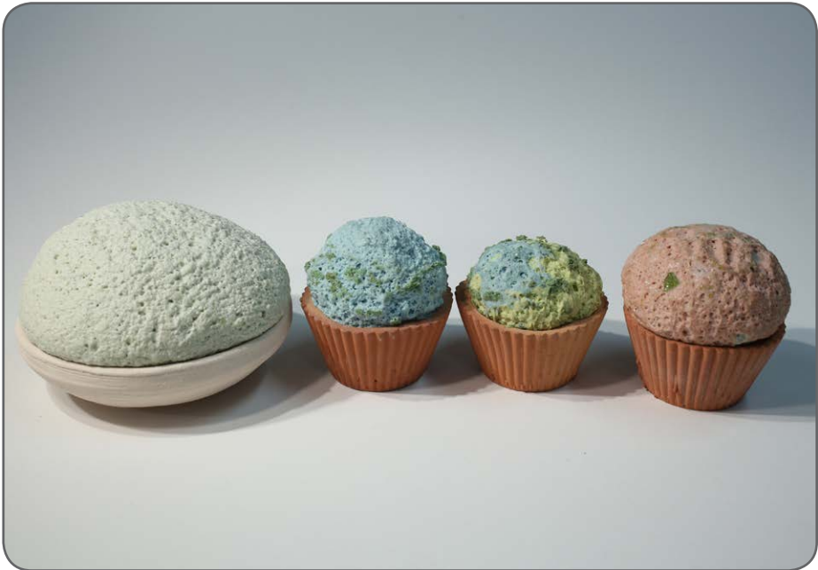
Kuva 16. Värijätty vaahtolasi vaahdotettuna keraamisiin kuppimuotoihin. (Kallioinen 2012).
