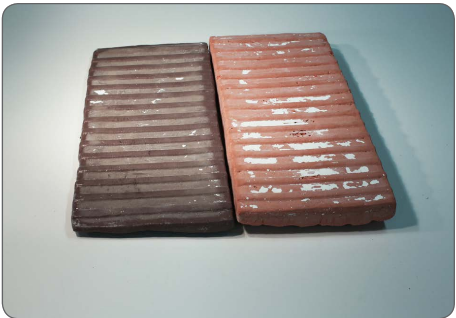
Kuva 21. Uunilevyn ja muotin suoja-aine jäi helposti kiinni väripigmenteillä värjättyihin kappaleisiin valkoisina läikkinä tai härmänä, joka ei pesemällä lähtenyt pois. (Vesterinen 2014.)
