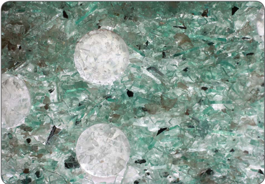
Kuva 10. Kehikko: biohartsikierrätyslasimurskavalu ja tuulilasi-murska.
