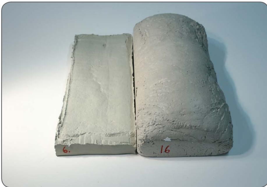
Kuva 9. Agenttikokeissa tutkittiin muun muassa vaahdottumiskorkeutta, valmiin vaahtolasin korkeutta verrattuna syötteen korkeuteen ennen polttoa. Osa koekappaleista vaahdotui pulleaksi leipämäiseksi muodoksi, osa muistutti enemmän tiivistä, keraamista laatua kuin vaahtolasia. (Vesterinen 2014.)
