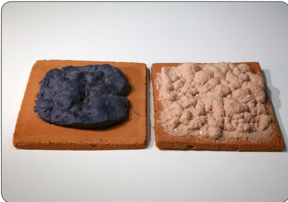
Kuva 15. Vaahtolasi vaahdottui ja tarttui tiiviisti kiinni punasavesta valmistettuun ja poltettuun keramiikkalaattaan. Kuvassa vaahtolasi on värjätty keraamisilla pigmenteillä. (Kallioinen 2012.)
