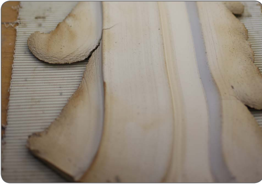
Kuva 15. Kivitavara-lasijauhemaasta puristettujen laattojen reunat repeilivät helposti.
