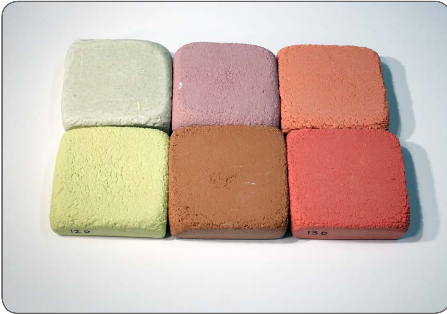
Kuva 22. Keraamisilla väripigmenteillä saatiin luotua vahtolasille laaja väriskaala, jota voidaan hyödyntää mm. sisustus ja julkisivutuotteissa. (Luostarinen 2014.)
