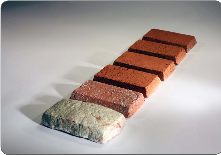
Kuva 3. Koepalat P-EP, polttolämpötila 1030 °C. Kun lasia on 60 %, kappale on vihreä ja pullistunut.
