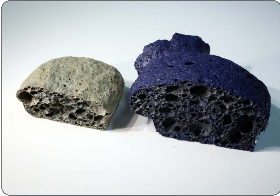
Kuva 19. Vahtolasin värjäämistä kokeiltiin eri värimetalliyhdisteillä ja keraamisilla väripigmenteillä. Kuplakoko oli osassa kokeita suuri ja rakenne heikko. Vasemmalla on keltaisella rautaoksidilla, oikealla sinisellä pigmentillä värjäytyt koekappaleet. (Ylitalo 2011.)
