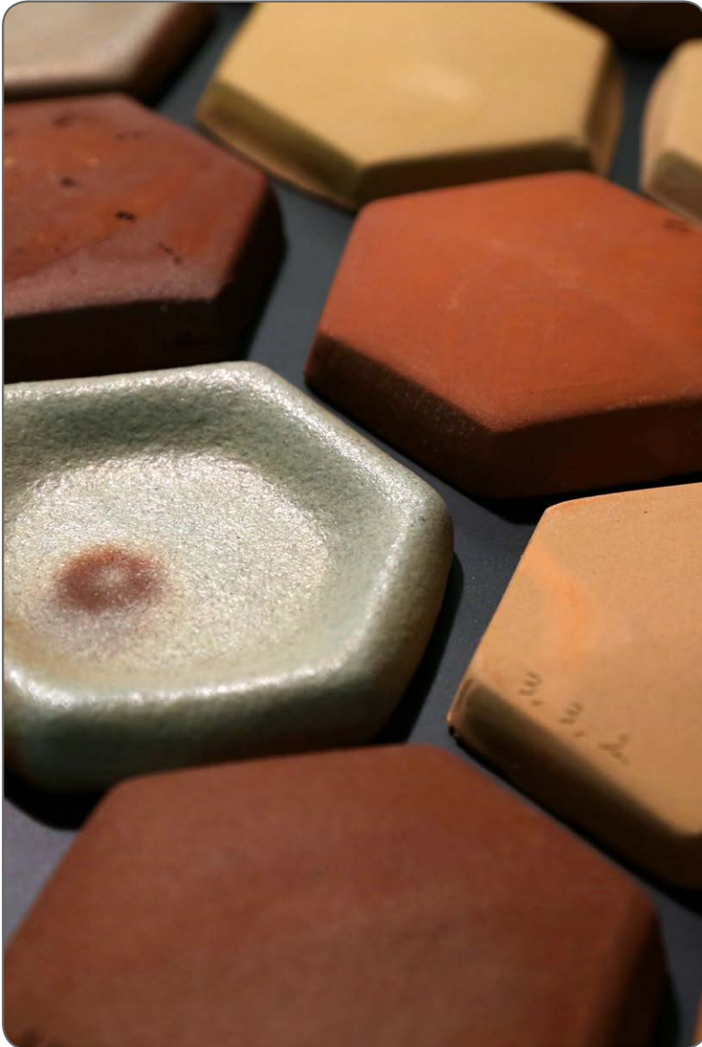
Kuva 20. Tanja Ylitalon (2013) valmistamia, eri määriä lasijauhetta sisältäviä ja eri lämpötiloihin poltettuja kuusikulmisiä Heksa-laattoja, joista voidaan rakentaa esteettisesti mielenkiintoista pintaa muun muassa sisustuksiin ja julkisivuihin.
