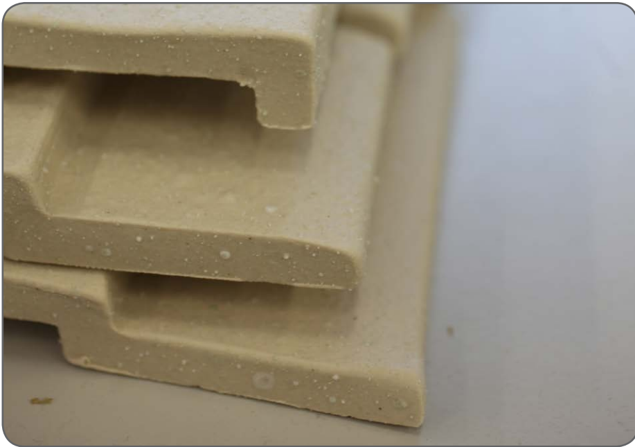
Kuva 16. Laatan pintaan nousi poltossa 1200 °C lämpötilassa lasimaisia kuplia.
