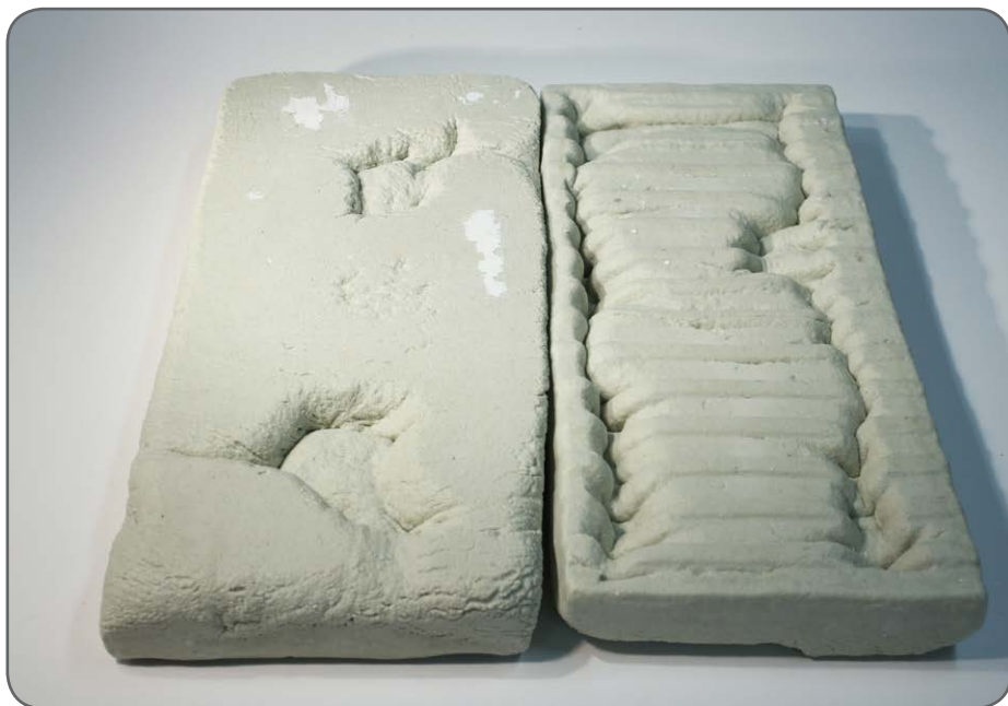
Kuva 13. Vahtolasilaattojen ongelmana olivat epämääräiset pullistumat, mikä vaikeutti tarkan muodon ja reliefipinnan valmistamista (Vesterinen 2014).
