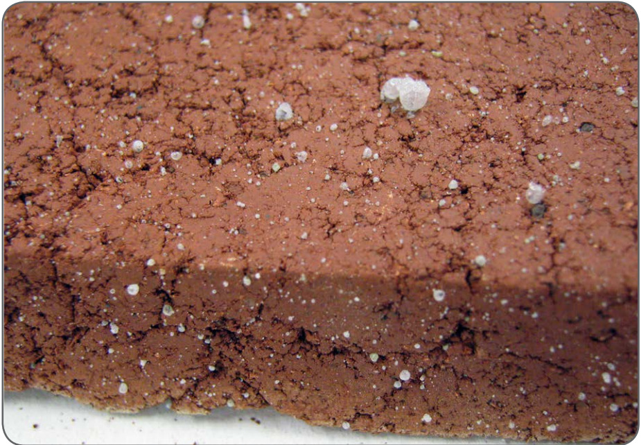
Kuva 2. Yli 1000 °C:n lämpötiloissa paljon lasijauhetta sisältäneiden koekappaleiden pintaan muodostui pieniä lasisia kuplia (Auvinen 2012a, 16).
