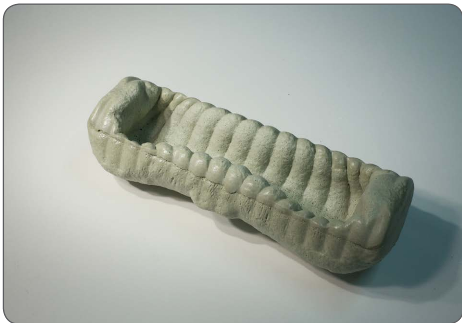
Kuva 14. Pullistaman syytä oli monissa poltoissa vahtolasiseoksen epätasainen lämpeneminen sintraantumisen ja vaahdottumisen aikana (Vesterinen 2014).
