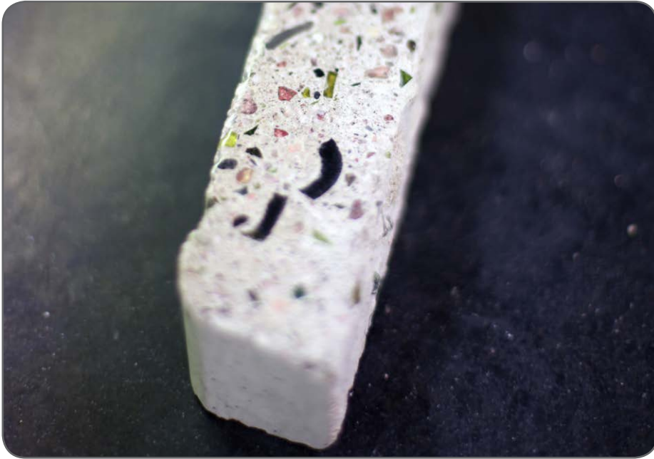
Kuva 4. Betonin sekaan valettua kierrätyslasimurskaa.
