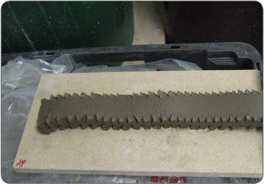
Kuva 10. Isommassa ja tehokkaamassa Gerhards-puristimessa saven reunojen repeily oli vähintäänkin yhtä voimakasta kuin pienemmässä koneessa.
