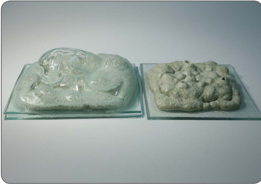
Kuva 17. Vaahtolasi vaahdotettuna ja yhteensulatettuna kahden float-lasin väliin ja lasin päälle (Kallioinen 2012).
