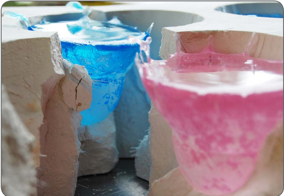
Kuva 15. Kipsi-molokiittimuotissa univalettua lasia.
