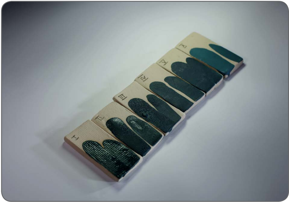
Kuva 1. Engobe-koesarjan 1 kokeet (vasemmalla I-koepala ja oikealla verrokki X).
