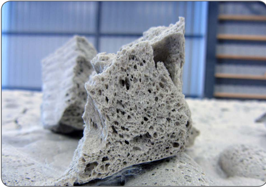
Kuva 12. Koeajossa vaahtolasin kuplakoko oli suurempi ja epätasaisempi kuin normaalissa tuotannossa.
