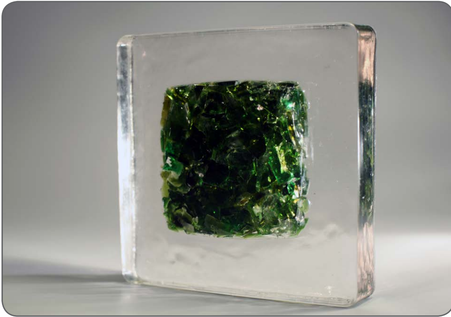
Kuva 7. Hartsikierrätyslasimurskavalun (vihreä pullolasi) ympärille valettiin hartsia.
