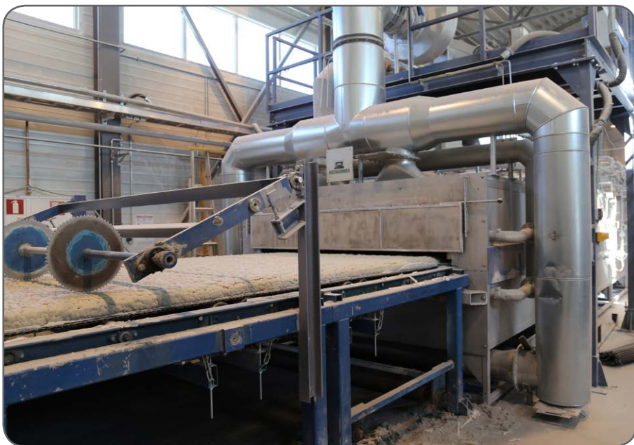
Kuva 10. Utta vaahdotusagenttia testattiin koeajossa Uusioaineksen tehtaalla. Kuvassa vaahtolasimassaa on tulossa ulos uunista.
