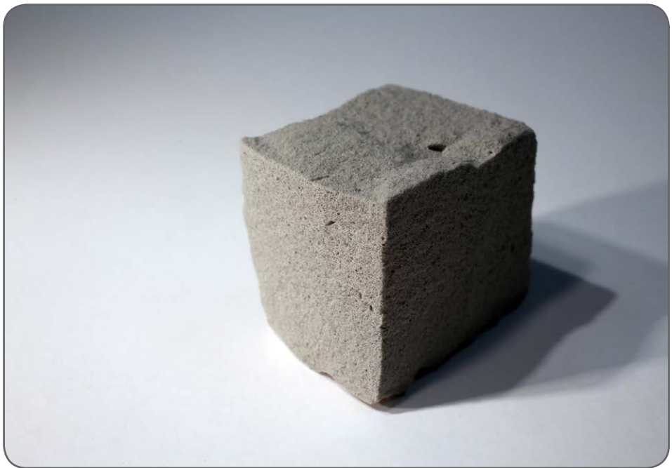
Kuva 1. Vaahtolasissa vaahtomainen lasiaines on täynnä pieniä ilmakuplia. Uusioaines Oy:n vaahtolasimurske.
