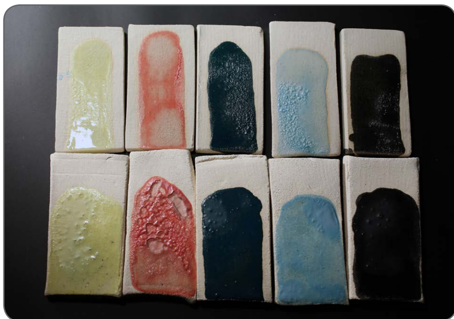
Kuva 2. Engobe-koesarjan 2 koepaloja, polttolämpötila 1220 °C (järjestys IA-IE vasemmalta oikealle).
