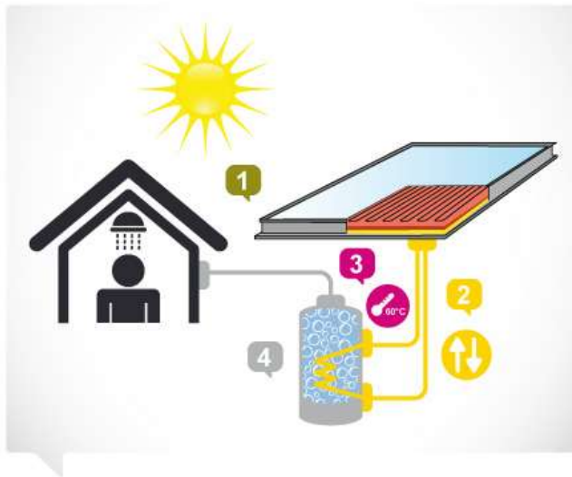
Figur 24. Solfångarens funktion i ett vattenburet värmesystem. [47]
