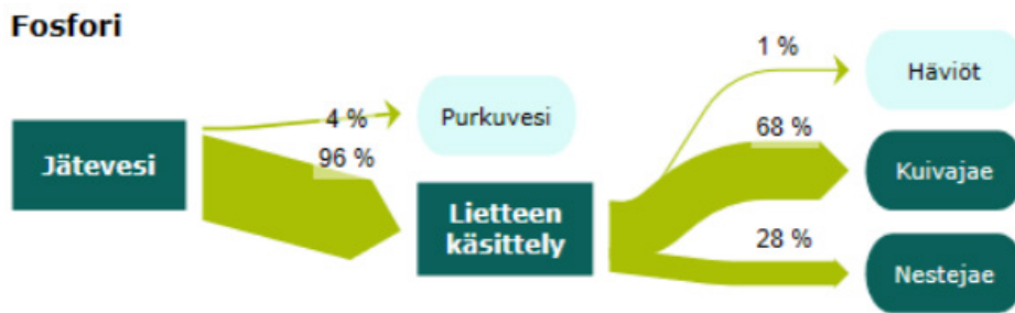
Kuva 4. Fosforin keskimääräinen jakautuminen jätevesilietteen käsittelyssä, mädätysmenetelmällä (Lehtonen ym., 2021, s. 14).
