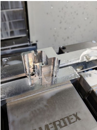
Kuva 3. Tarttujan rungon koneistaminen.
