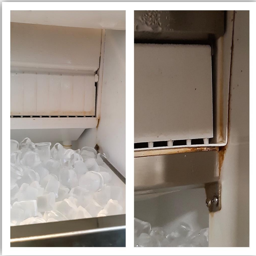
Kuva 5. Jääpalakoneissa näkyvää keltaista värjäytymää (vas.) ja ruskeaa likaa (oik.).
