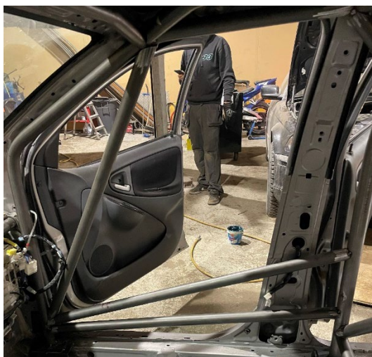
Kuva 6. WRC-putki ja oviputket.
