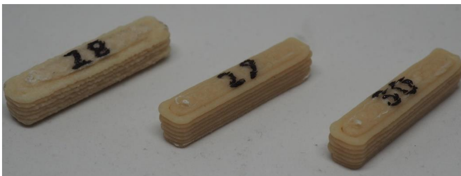
Kuva 16. Formi 3D:stä 2,0 mm kokoisella suuttimella tulostetut testipalikat.
