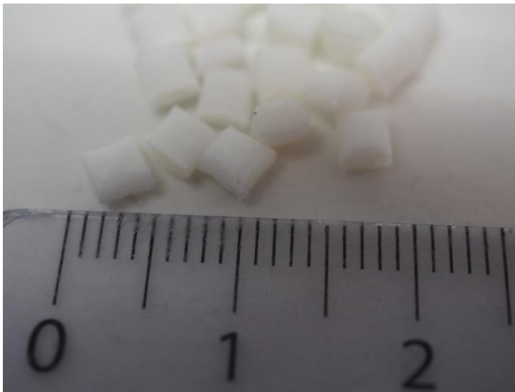
Kuva 9. PLA-Fi:n granulaattia viivaimen vieressä.
