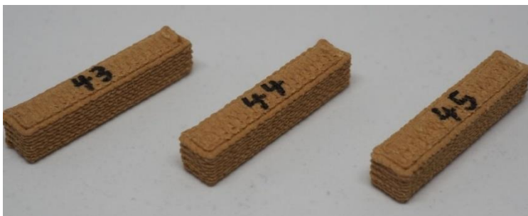
Kuva 29. Durasensestä 1,0 mm kokoisella suuttimella tulostetut testipalikat.
