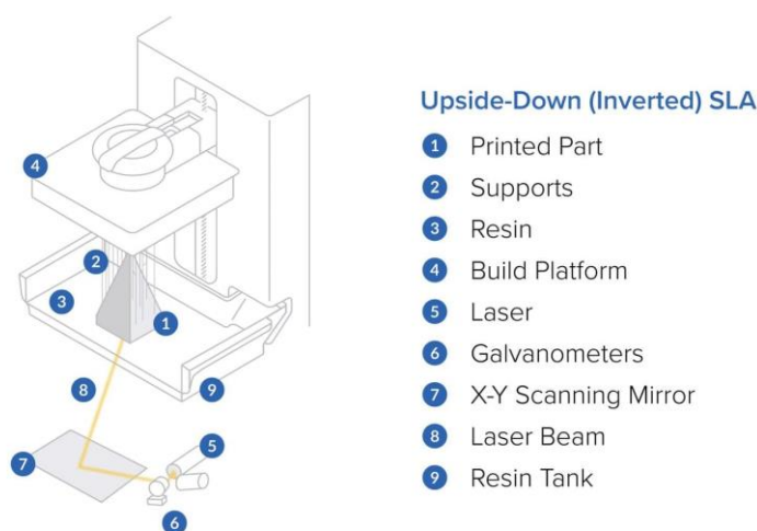
Kuva 1. Stereolitografiatulostimen eri osat (Formlabs n. d.).
