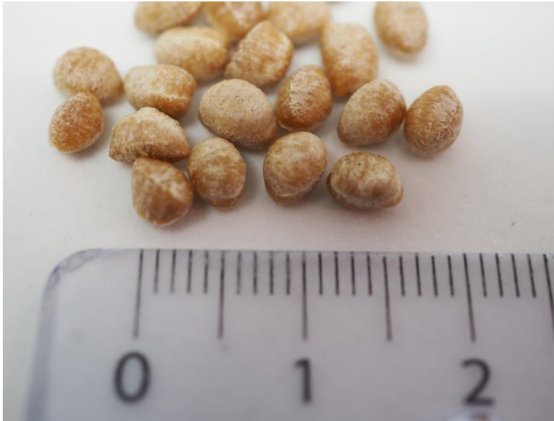
Kuva 11. Durasense 3D Plus 50:n granulaattia viivaimen vieressä.
