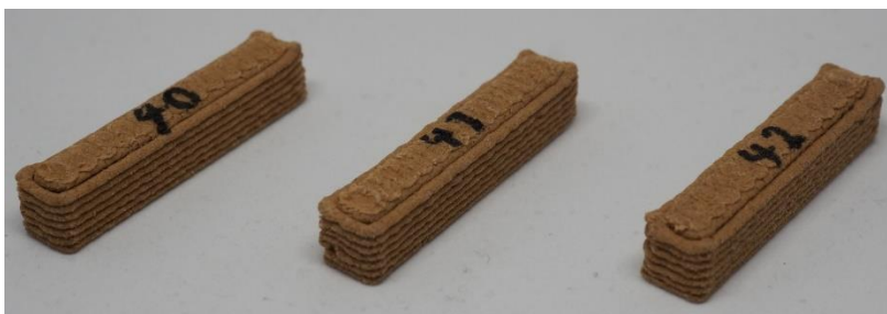
Kuva 28. Durasensestä 1,5 mm kokoisella suuttimella tulostetut testipalikat.
