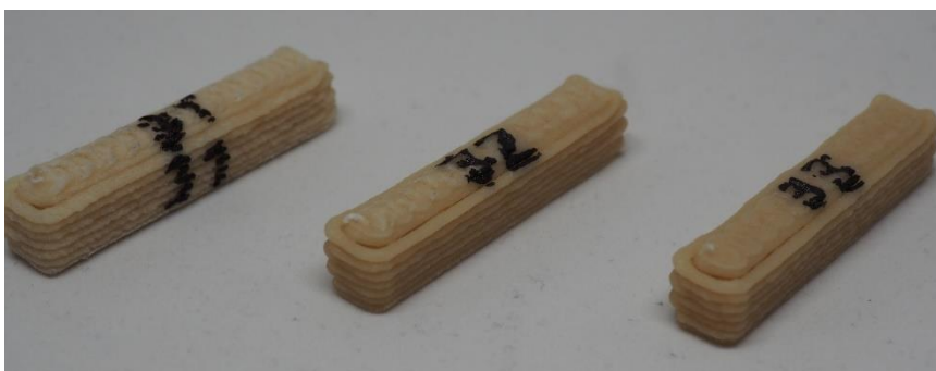
Kuva 17. Formi 3D:stä 1,5 mm kokoisella suuttimella tulostetut testipalikat.
