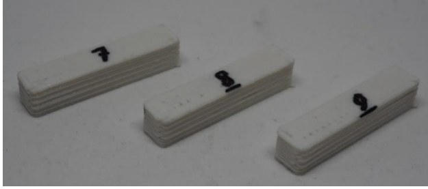
Kuva 14. Biodolomerista 1,0 mm kokoisella suuttimella tulostetut testipalikat.
