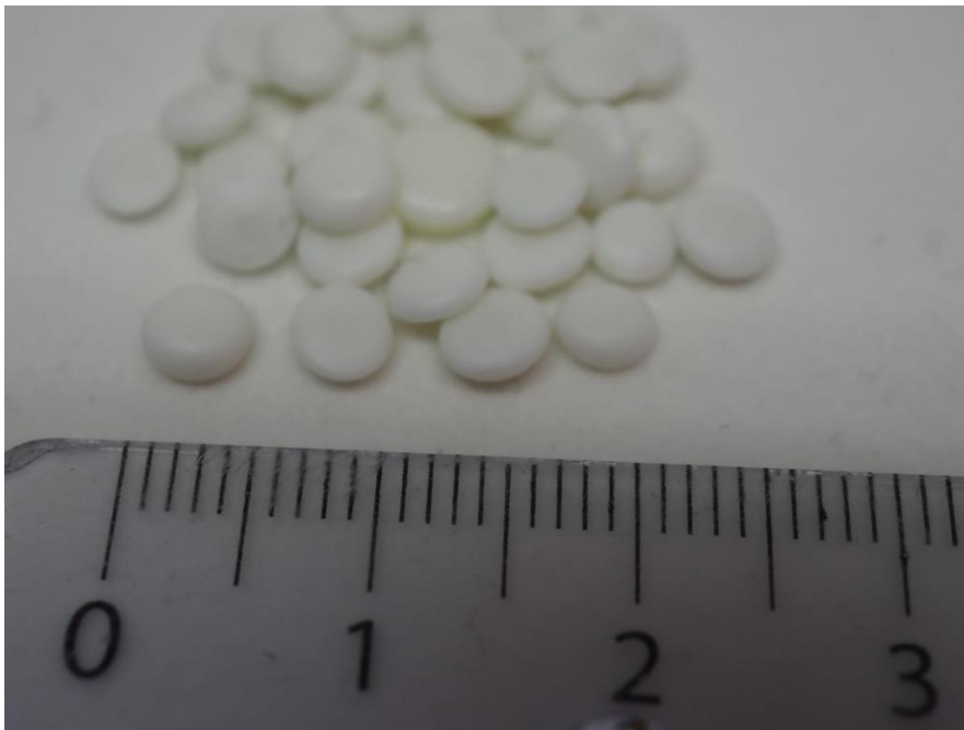
Kuva 7. Biodolomerin granulaattia viivaimen vieressä. Asteikko senttimetreinä.
