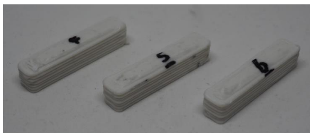
Kuva 13. Biodolomerista 1,5 mm kokoisella suuttimella tulostetut testipalikat.
