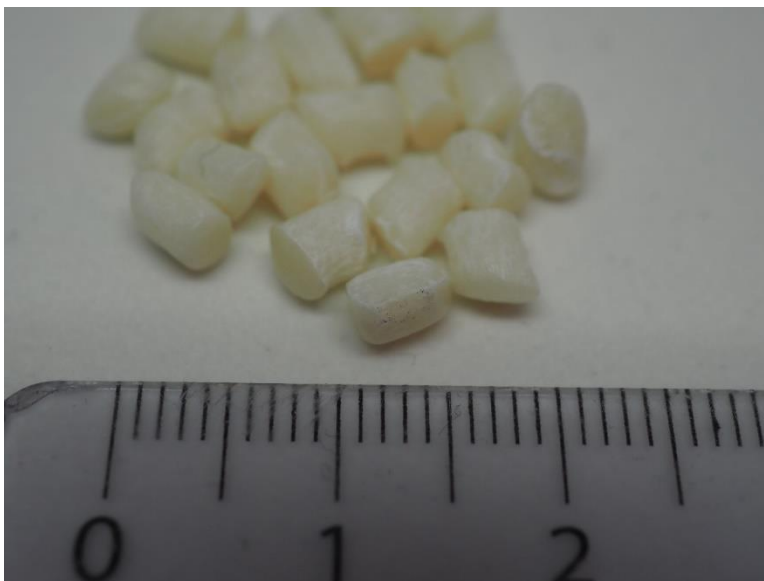
Kuva 8. Formi 3D:n granulaattia viivaimen vieressä.
