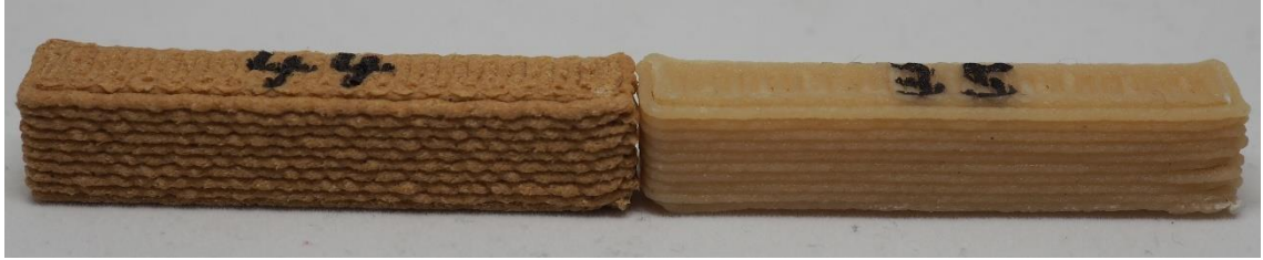
Kuva 30. Durasense 3D:stä (vas) ja Formi 3D:stä (oik) 1,0 mm suuttimella ja 50 %:n täyttöasteella tulostetut testikappaleet.
