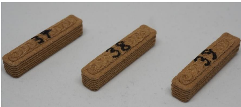
Kuva 27. Durasensestä 2,0 mm kokoisella suuttimella tulostetut testipalikat.
