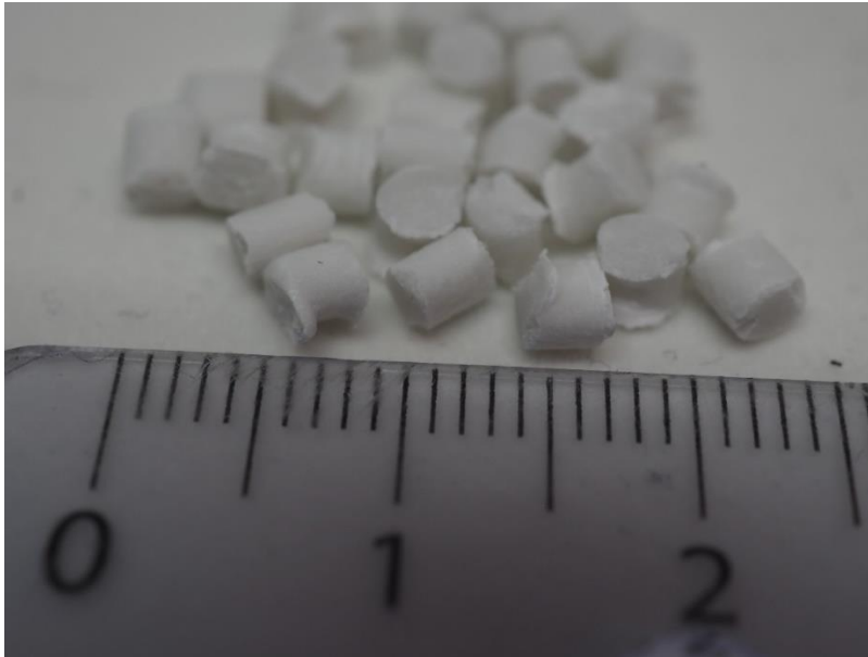
Kuva 10. PLA Mi:n granulaattia viivaimen vieressä.
