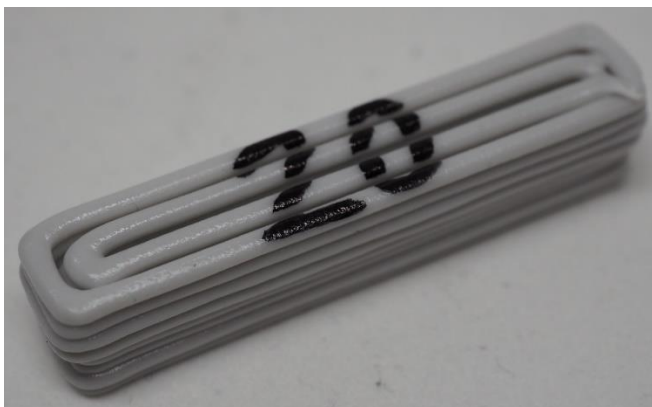
Kuva 23. Aukkoinen PLA-Mi:stä valmistettu testikappale.
