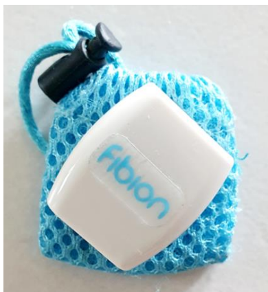
Kuva 5 Fibion Oy:n kiihtyvyyssanturitekologiaan perustuva mittalaite
