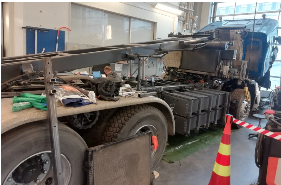
KUVA 1. Sähkökäyttöiseksi muutettava kuorma-auto
