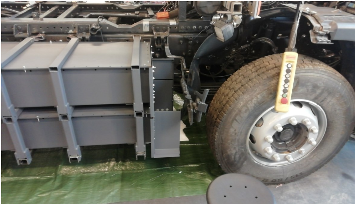
KUVA 11. Akuston koteloinnin etuosa
