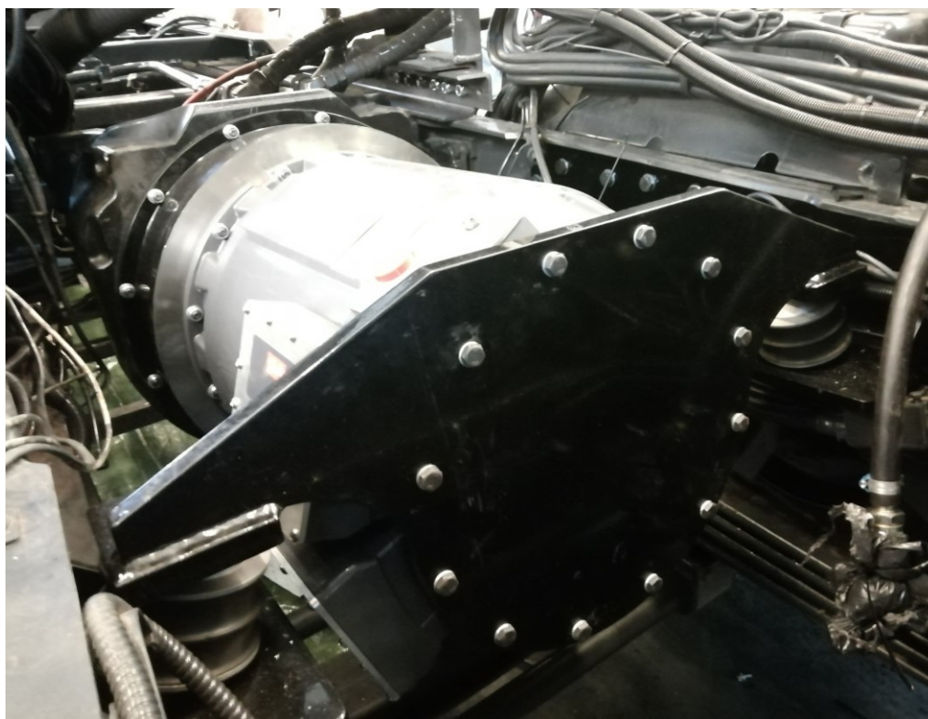
KUVA 6. Sähkömoottori ja sen kiinnitys
