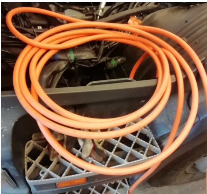
KUVA 7. Ulkokuoreltaan oranssi korkeajännitekaapeli
