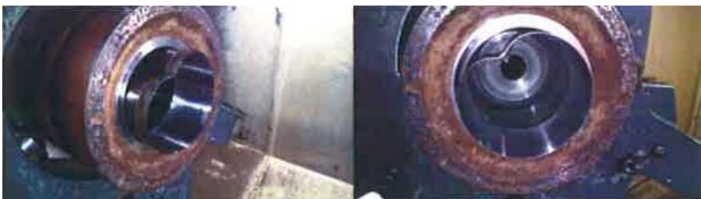
Kuva 32. Akselitumpin irrotus. (Siemens VAI Metals Technologies GmbH 2014, 37)
