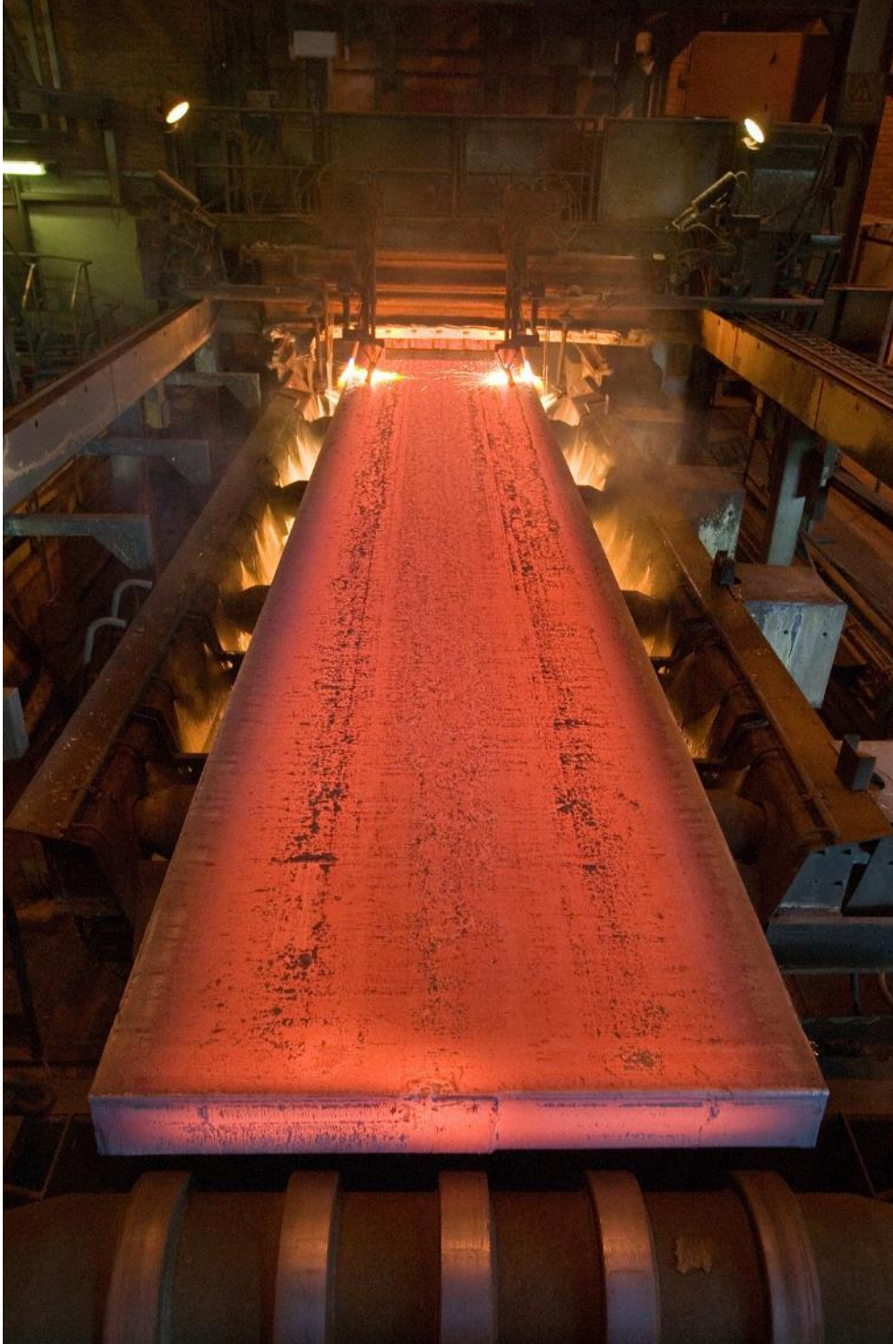
Kuva 2. Teräsaihion polttoleikkaus määrämittaan jatkuvavalun päätteeksi. (SSAB 2022e.)
