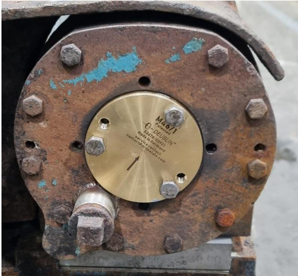
Kuva 19. Pyörivän liittimen asennussuunta.
