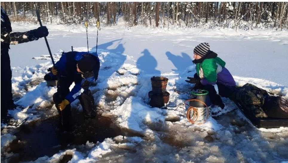
Kuva 28. Karelia-ammattikorkeakoulun opiskelija Ismo Pöllänen valmistautuu ottamaan laippakairalla sedimenttinäytettä Aittokorvenlammella helmikuussa 2021. Eetu Niiranen lämmittää nestekaasutoholla vettä laitteiden sulattamiseen.
