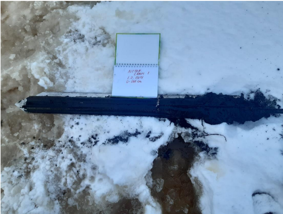
Kuva 48. Laippakairalla otettu sedimenttinäyte 0-100 cm Aittokorvenlammen keskiseltä havain- topaikalta 1 01.02.2021.
