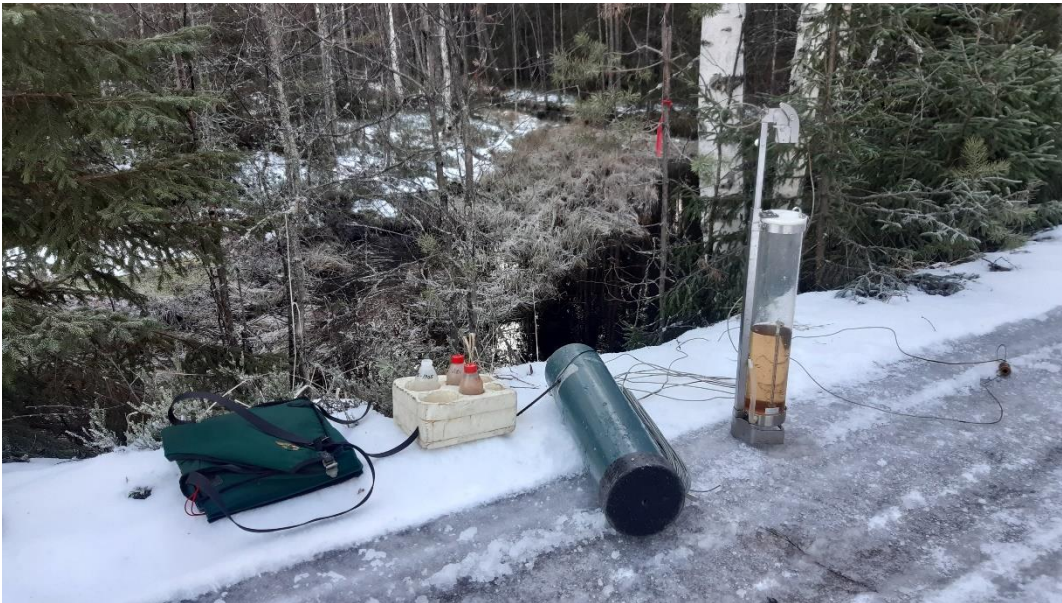
Kuva 23. Limnos-vesinäytteenotin ja muut virtavesinäytteenotossa tarvittavat välineet Kissanpuuron Alatammen havaintopaikalla joulukuun alussa 2020.
