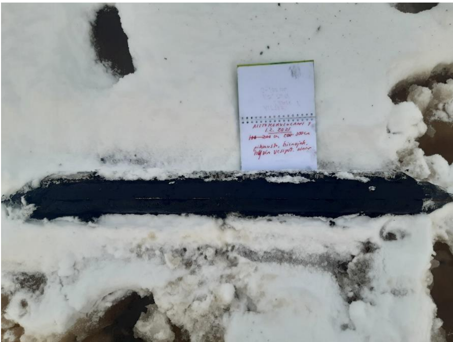
Kuva 50. Laippakairalla otettu sedimenttinäyte 200-300 cm Aittokorvenlammen keskiseltä havaintopaikalta 1 01.02.2021.
