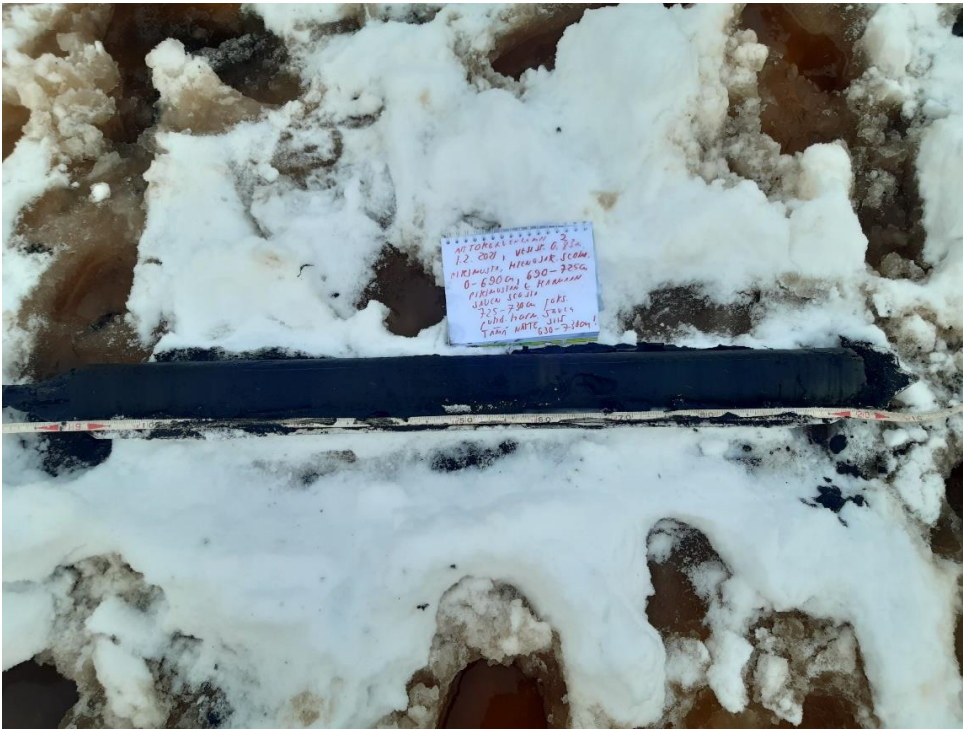
Kuva 53. Laippakairalla otettu sedimenttinäyte 630–730 cm Aittokorvenlammen luoteiselta havaintopaikalta 2 01.02.2021.
