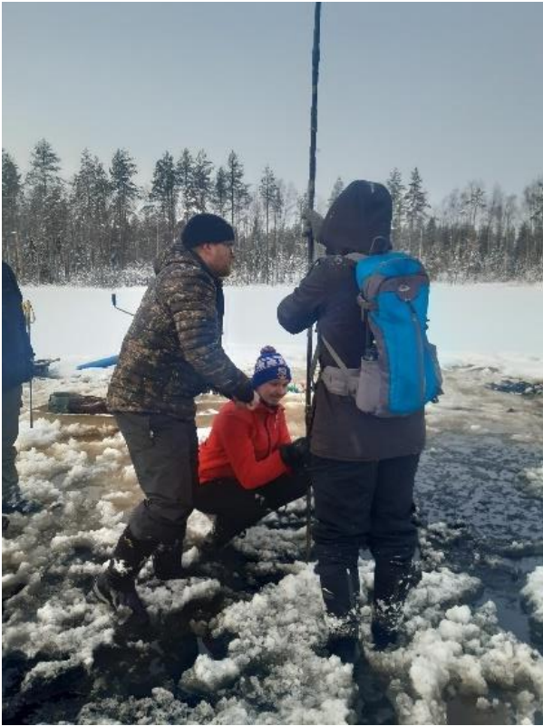
Kuva 27. Karelia-ammattikorkeakoulun energia- ja ympäristötekniikan opiskelijat (vasemmalta lukien) Ville Hirvonen, Kuisma Martikainen ja Eetu Niiranen lataavat laippakairaa sedimenttinäytteenottoa varten Aittokorvenlammella 01.02.2021.
