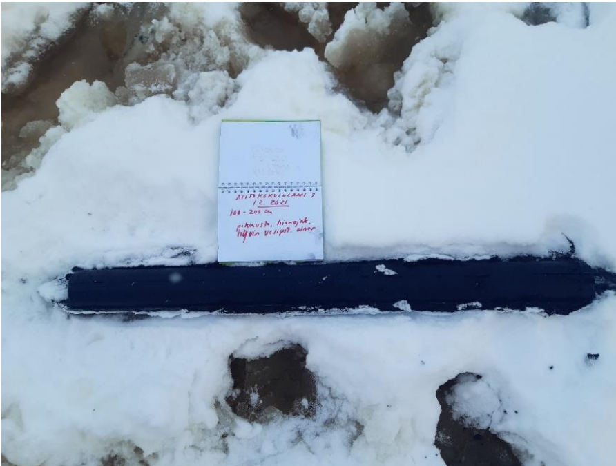
Kuva 49. Laippakairalla otettu sedimenttinäyte 100-200 cm Aittokorvenlammen keskiseltä havaintopaikalta 1 01.02.2021.
