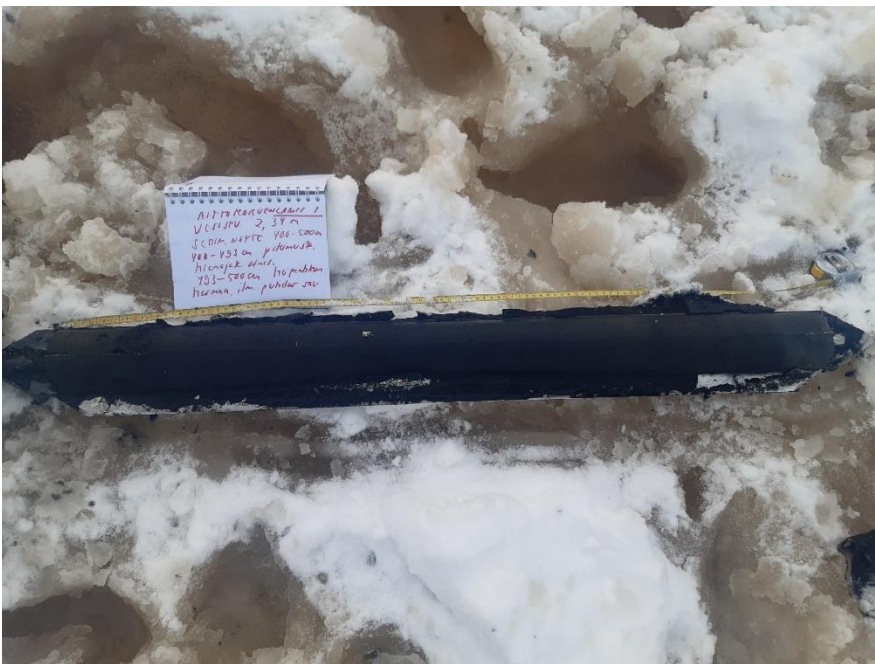
Kuva 52. Laippakairalla otettu sedimenttinäyte 400–500 cm Aittokorvenlammen keskiseltä havaintopaikalta 1 01.02.2021.
