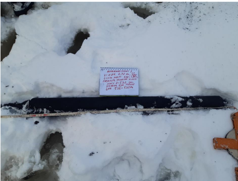
Kuva 54. Laippakairalla otettu sedimenttinäyte 493–593 cm Aittokorvenlammen eteläiseltä havaintopaikalta 3 01.02.2021.
