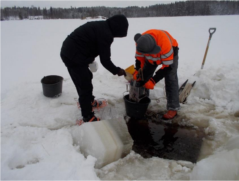
Kuva 25. Järven pohjaeläinnäyte on juuri otettu Ekman-noutimella Kerimäen Kuonanjärvellä huhtikuussa 2018. Kuva: Joanna Latoszek.
