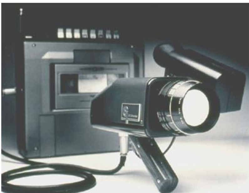
Kuva 3. ISI Videotherm, valmistettu vuonna 1980. IRINFO.ORG (2017)
