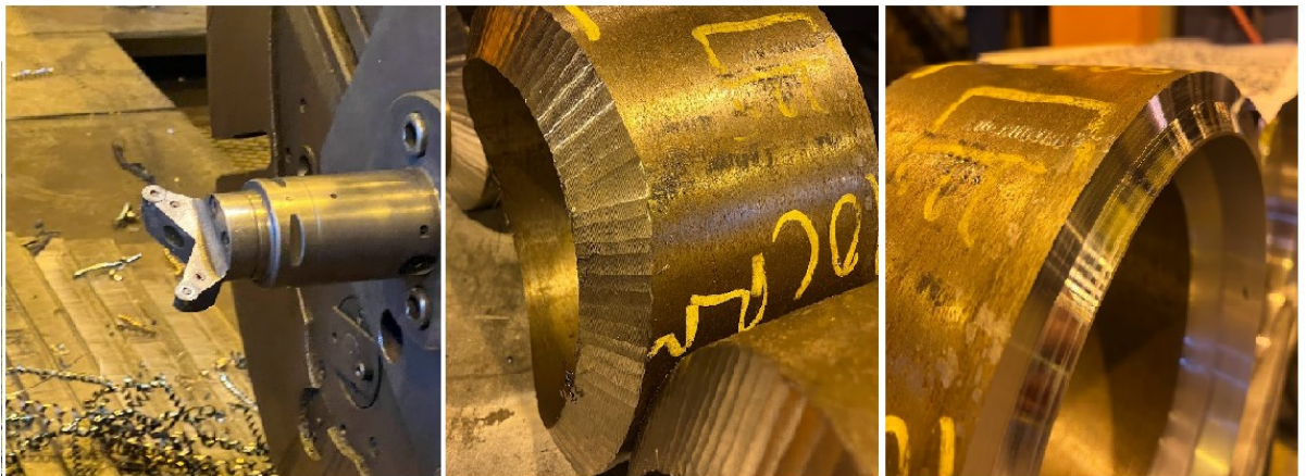
Kuva 2. Aarporan terä ja koneistettuja putkenpäitä aarporauksen jälkeen.
