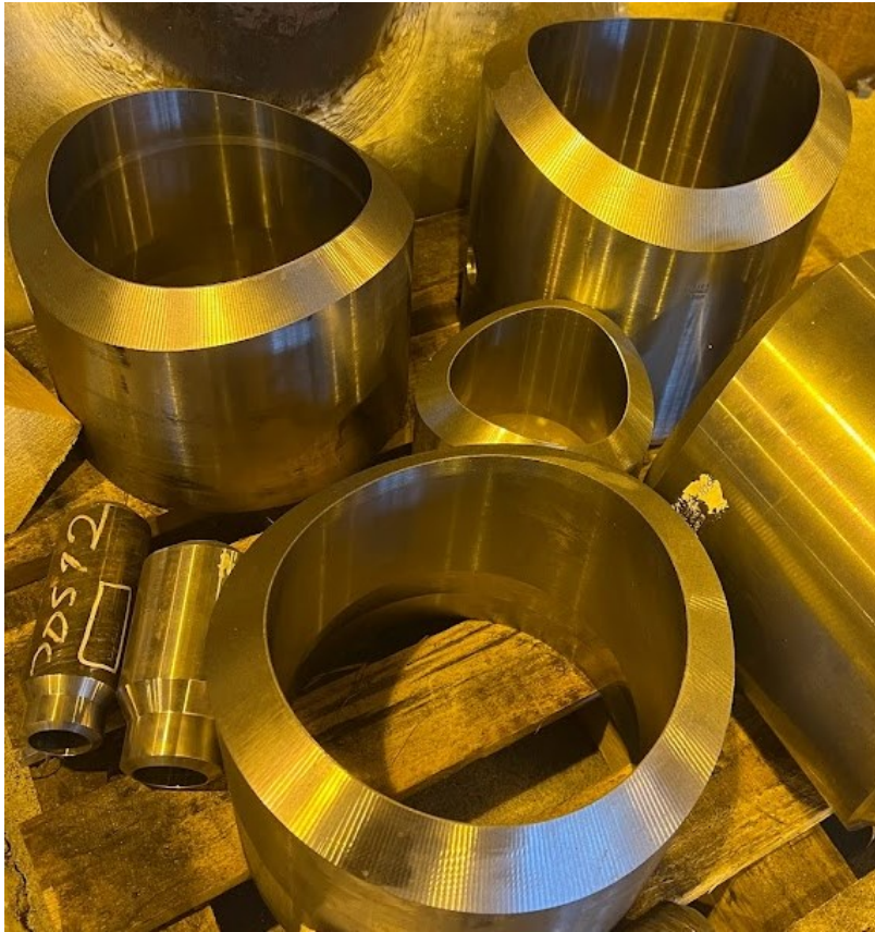
Kuva 39. Pajan valmistamia haaroitusyhteitä koneistettuine viisteineen.
