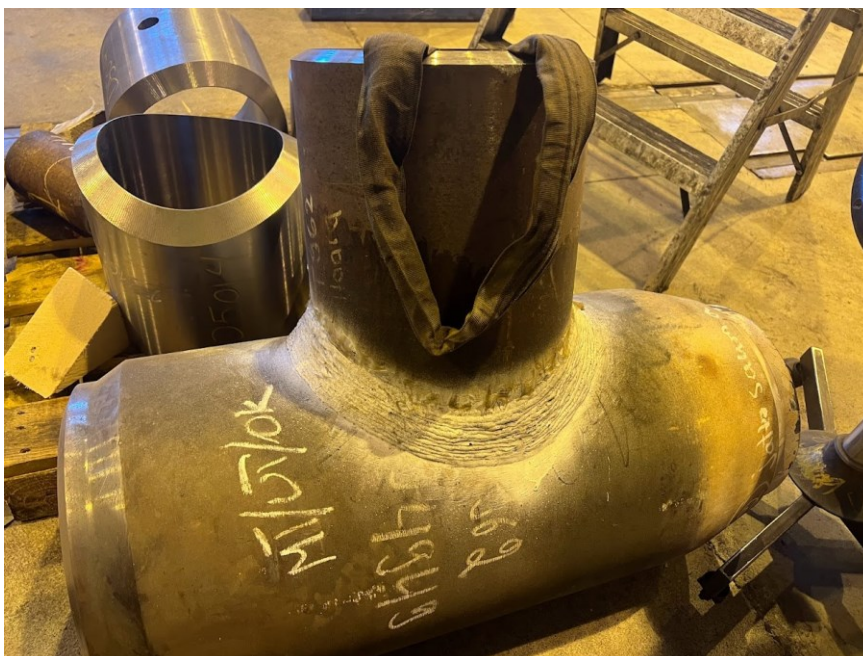
Kuva 3. Haaroituskappale, jossa tuoreeltaan runkoputken hitsattu yhde.
