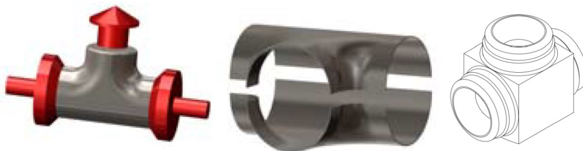
Kuva 1. T-kappaleen valmistus vetämällä, prässäämällä ja koneistamalla [1; 2, muokattu].
