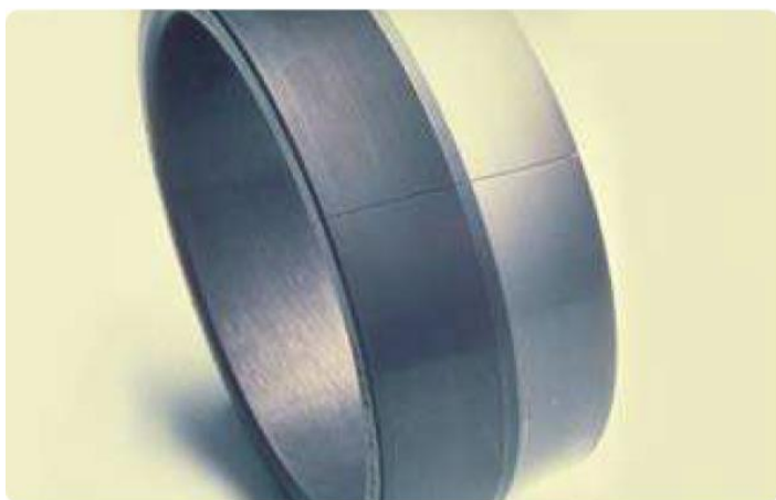
KUVA 12. Kehäjännityksen murtama laakerin sisärenkas (11, s. 301)
