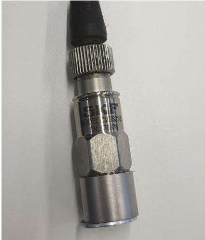
KUVA 17. Työssä käytettävä kiihtyvyyssanturi
