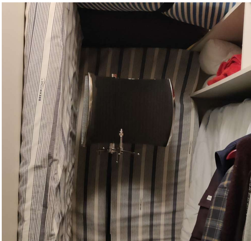
Kuva 5. Mikrofonitelineen ympärille kasattiin ensimmäiseksi vaimentavat materiaalit
