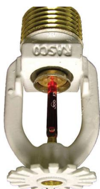
Kuva 3. Sprinklerisuutin, keskellä oleva punaisen ampullin rikkoutuminen laukaisee suuttimen [13].
