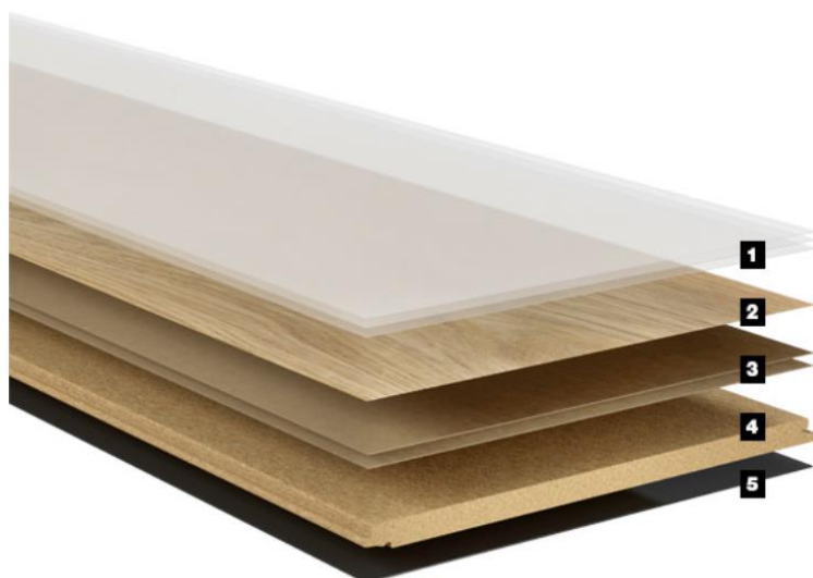
Kuva 12. Laminaattilattian rakenne (Pergo 2022)
