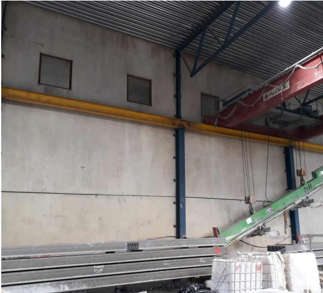
Kuva 14. Väärä toimintatapa, joka rasittaa siltanosturia sekä nostopuomia.
