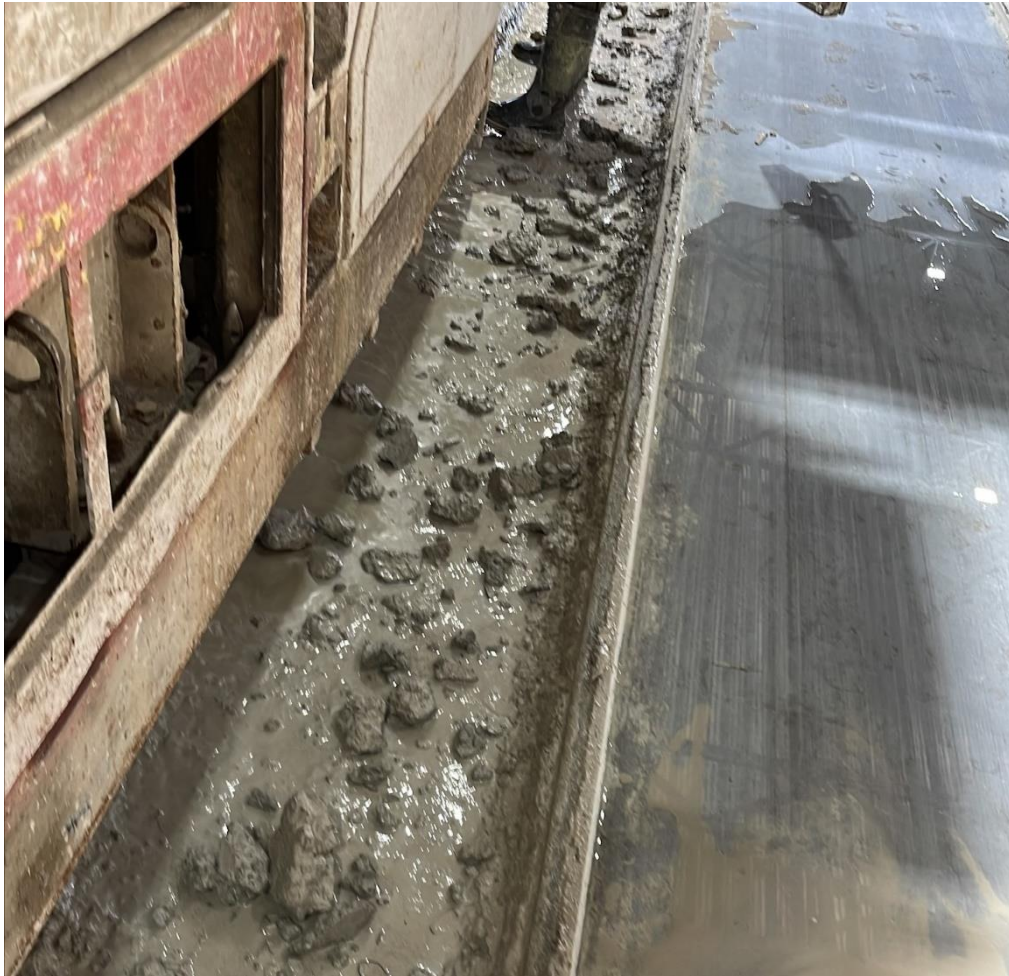
Kuva 15. Linjastojen välisissä kouruissa paljon tuotannosta syntyvää betonijätettä ja vettä.
