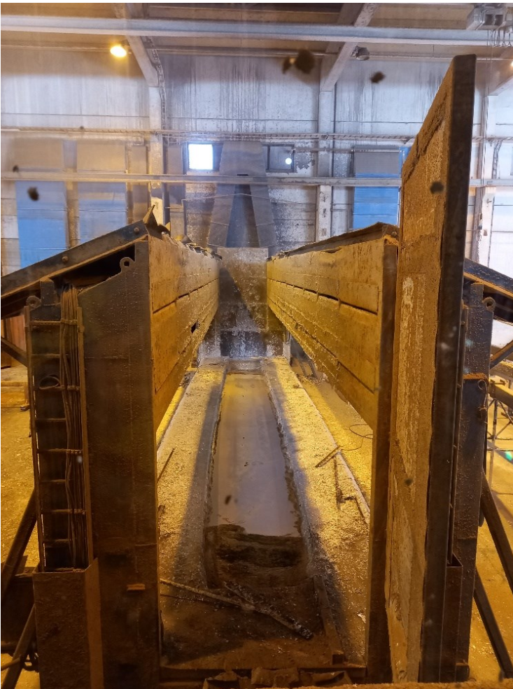
Kuvio 18 Lievestuoreen huuvan rakenne ja sinkityspata
