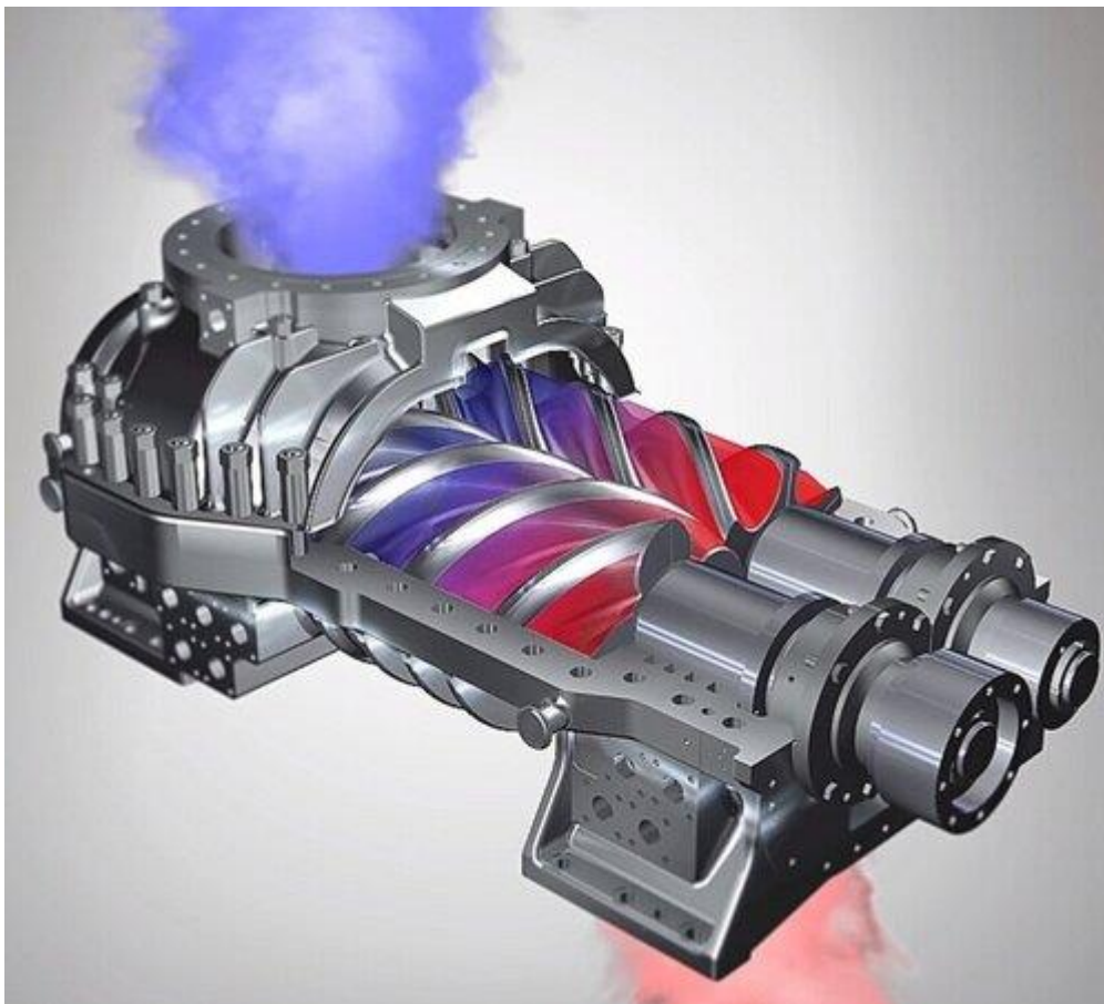
Kuva 8 Ruuvikompressorin toimintaperiaate (Mc-castengineering.com 2022)
