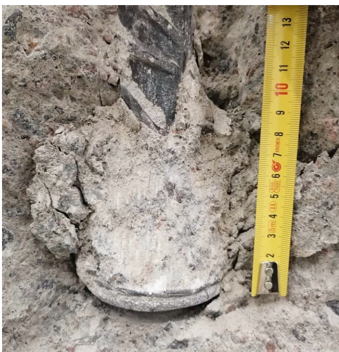
Kuva 23. Pultin E11P4 tyssän päälle muodostunut betonimurskeesta kartio.
