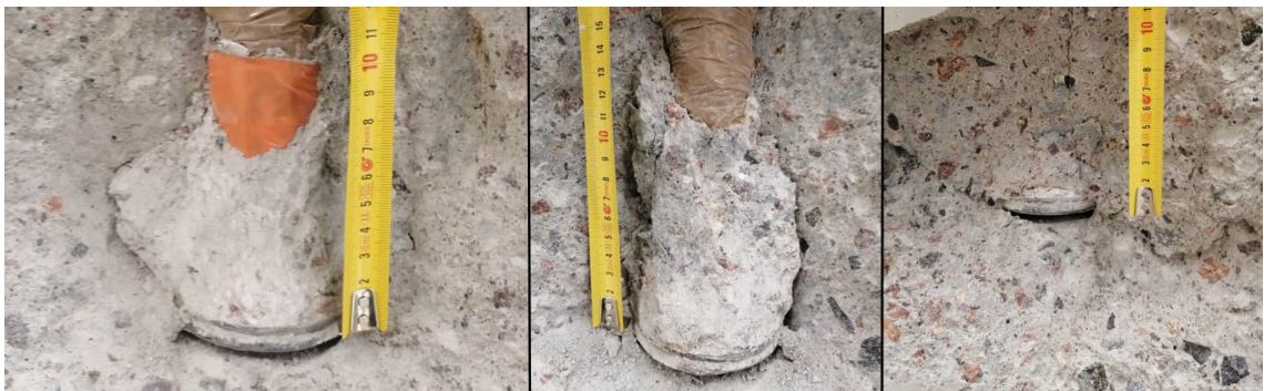
Kuva 25. Tyssän päälle muodostuneet kartiot pulteissa E11P10, E11P11 ja E11P12.
