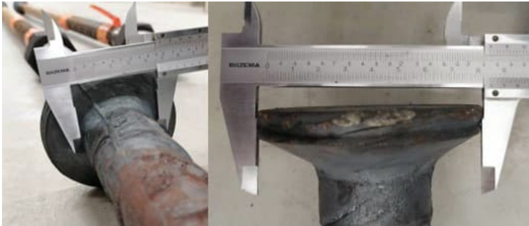
Kuva 15. Ankkurin halkaisija d_a on 40 millimetriä ja tyssän halkaisija d_h on 81 millimetriä.
