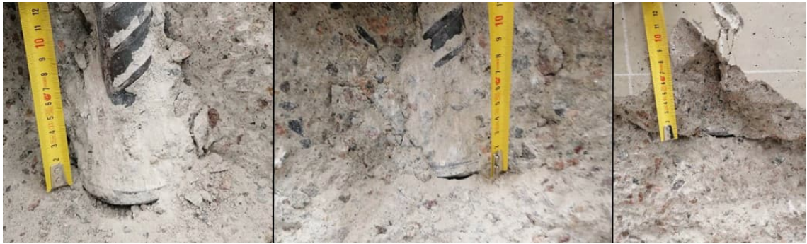
Kuva 24. Tyssän päälle muodostuneet kartiot pulteissa E11P7, E11P8 ja E11P9.
