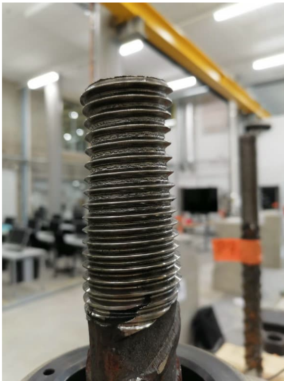
Kuva 26. Kierreosassa tapahtui teräsmurto.
