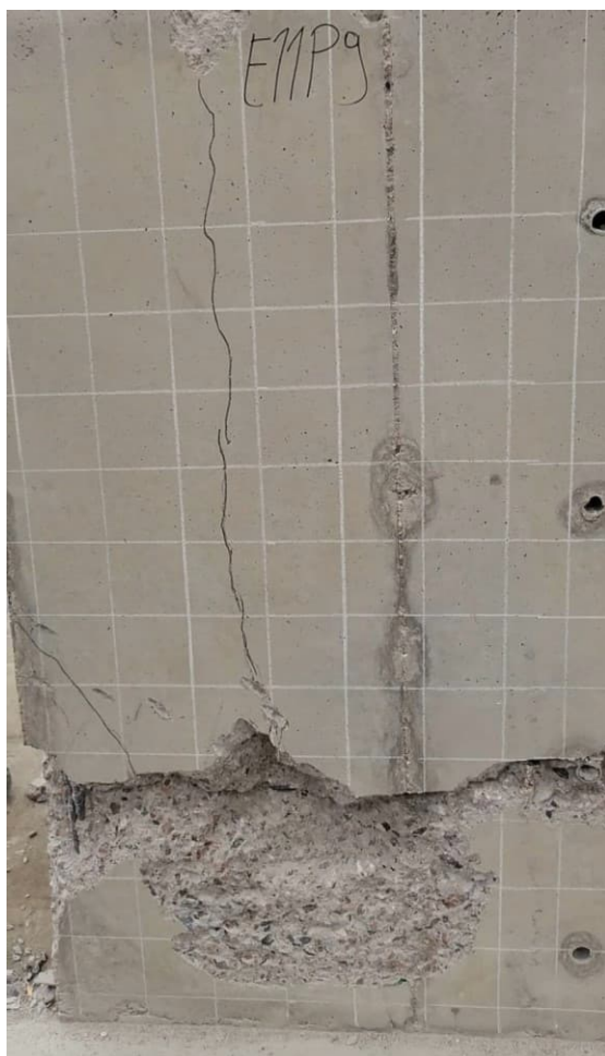
Kuva 34. E11P9 sivukartiomurtuma sekä halkeama vahvistettuna lyijykynällä.
