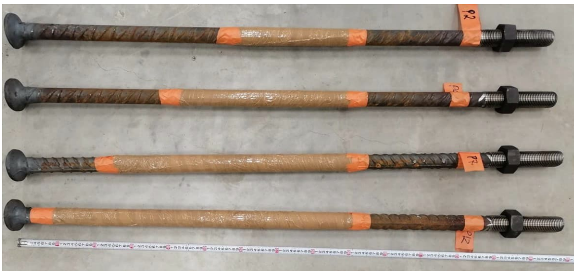
Kuva 13. Tartunta poistettiin suojapahvilla ja teipillä. (Kuva: Laura Ajanki)
