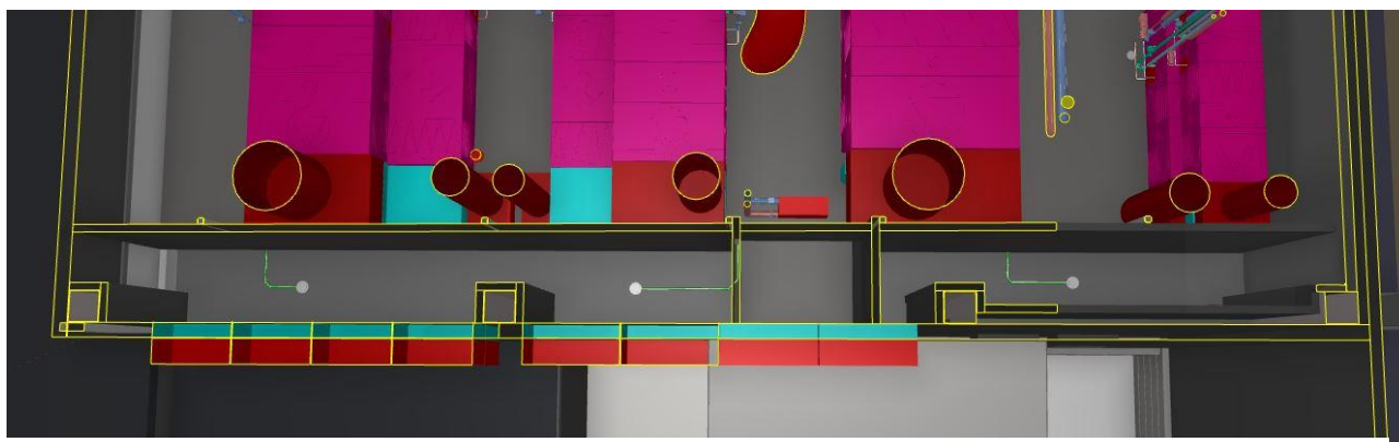
Figur 22. Luftkammaren i tredje våningens teknikrum. Skärmbild från Dalux.
