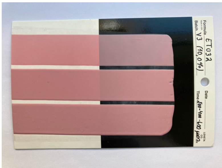
Kuva 7 V3-version (10 %) valumakestotesti 200 \mu\text{m} , 400 \mu\text{m} ja 600 \mu\text{m} raidan paksuuksilla.
