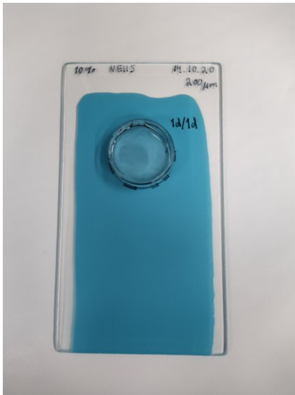
Kuva 16 Aikaisen vedenkeston testausta.
