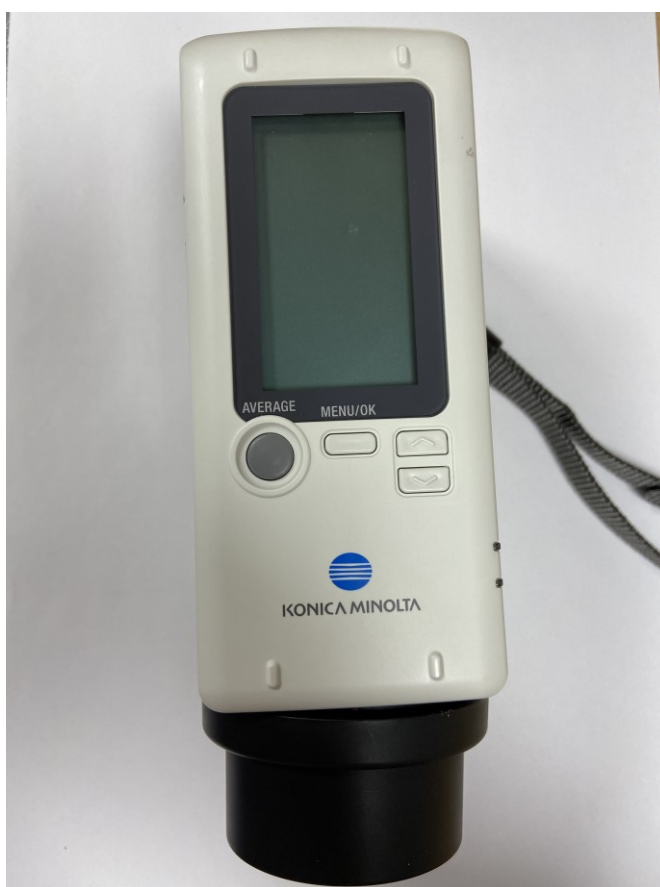
Kuva 2. Konica Minolta -värimit­tari, jolla mitattiin hampurilaissämpylöiden väriä.
