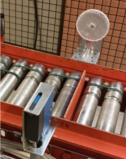
Kuva 12. Yläkuljettimen uusi peilistä heijastava anturi
