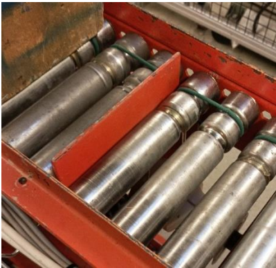
Kuva 2. Paineilmalla nouseva pysäytyslevy kuljetinlinjastolla.
