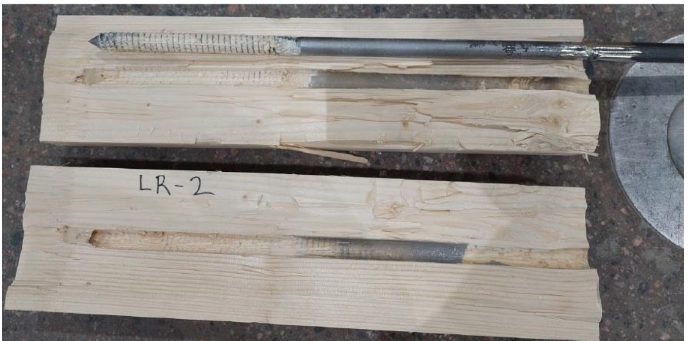
Kuva 8. Testin jälkeen halkaistu tartunnasta murtunut liimaruuviliitos LR-2-2.
