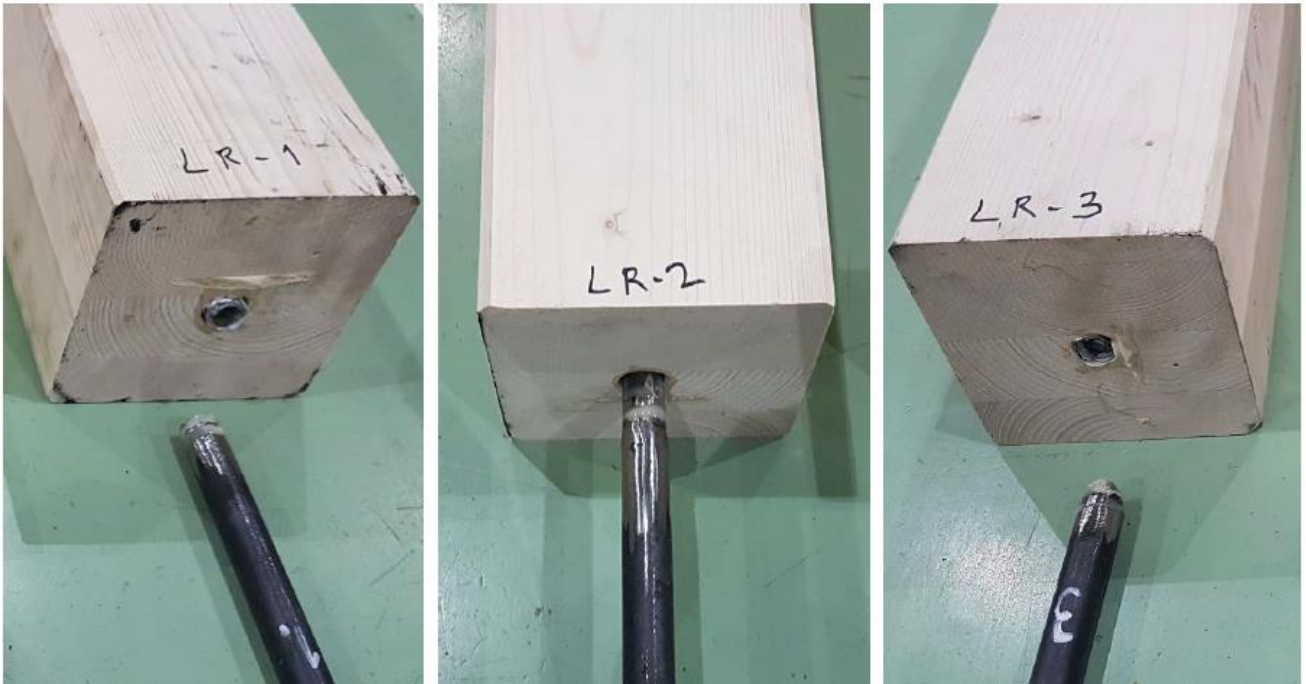
Kuva 7. Murtoon kuormitetut liimaruuviliitokset.
